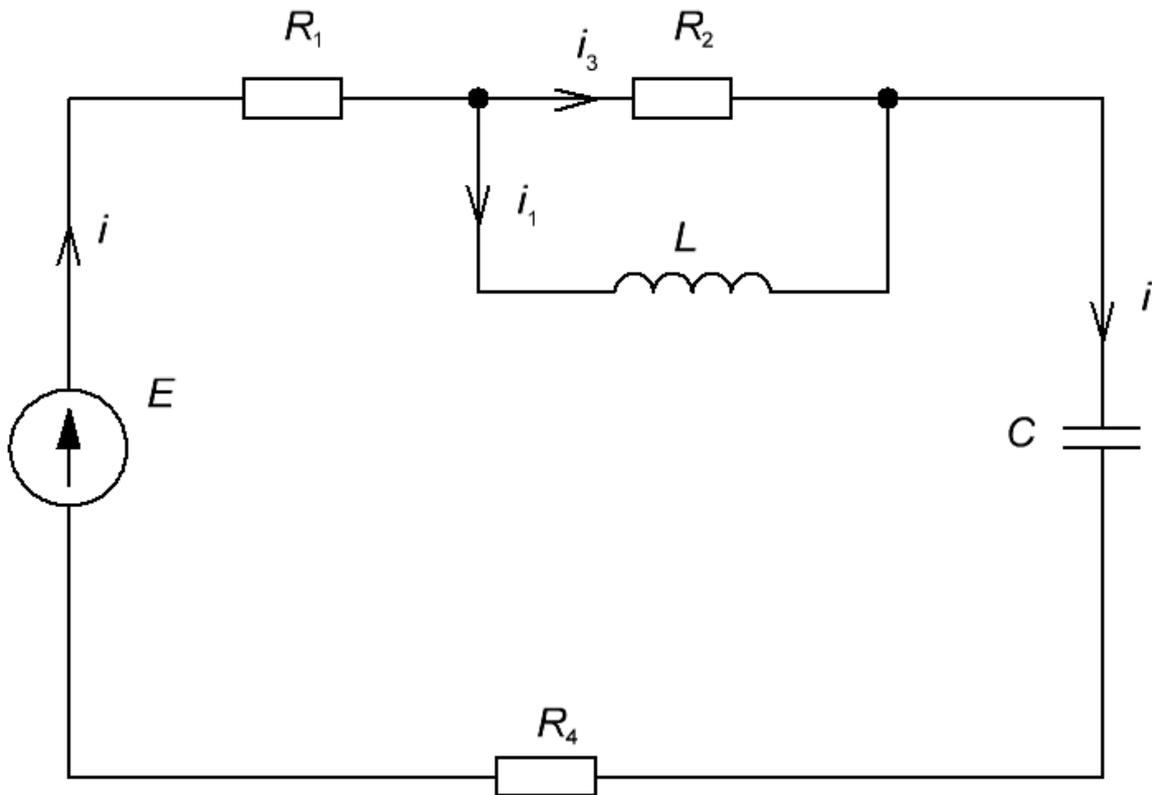
Составляем характеристическое уравнение. Запишем входное сопротивление цепи относительно источника ЭДС:
