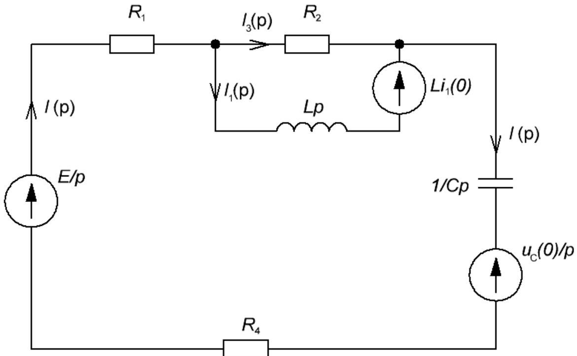
Запишем систему уравнений согласно законам Кирхгофа и решим её относительно  $I_3(p)$  методом исключения переменных:
