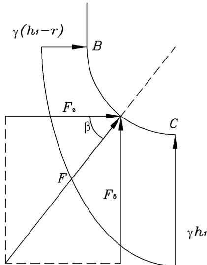
Из эпюры видно, что все силы давления направлены по радиусам четверти окружности BC, следовательно, и линия действия  $F$ , как равнодействующей, обязана пройти тоже через центр окружности. Тангенс угла  $\beta$  наклона линии действия силы  $F$  к горизонту определяется по формуле:
