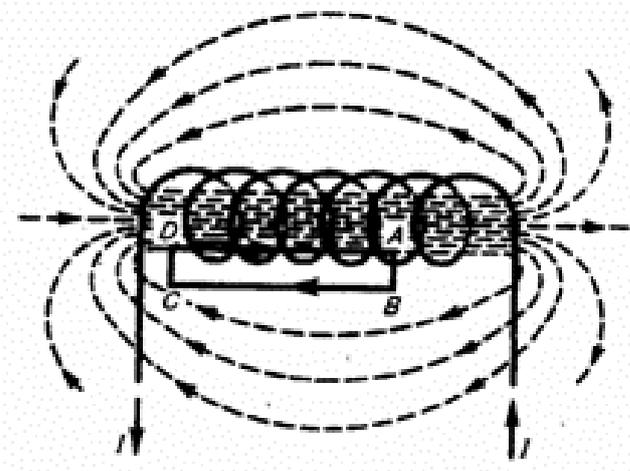
Интеграл по  $ABCD$  можно разложить на четыре интеграла: по  $AB$ ,  $BC$ ,  $CD$  и  $DA$ . На участках  $AB$  и  $CD$  контур и линии магнитной индукции перпендикулярны:  $B_l = 0$ . На участке  $BC$  вне соленоида  $B = 0$ . На участке  $DA$  циркуляция вектора  $\vec{B}$  равна  $B_l$  (контур и линии магнитной индукции совпадают); значит,
