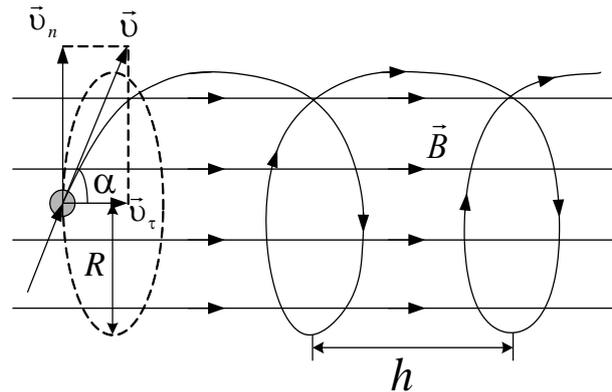
Очевидно, что  $\vec{v}$  не перпендикулярен  $\vec{B}$ , так как электрон движется по винтовой линии. Обозначим угол между  $\vec{v}$  и  $\vec{B}$  через  $\alpha$ . Движение электрона можно представить в виде суперпозиции равномерного прямолинейного движения вдоль поля со скоростью  $v_\tau = v \cdot \cos \alpha$  и равномерного движения по окружности со скоростью  $v_n = v \cdot \sin \alpha$ . Тогда по второму закону Ньютона
