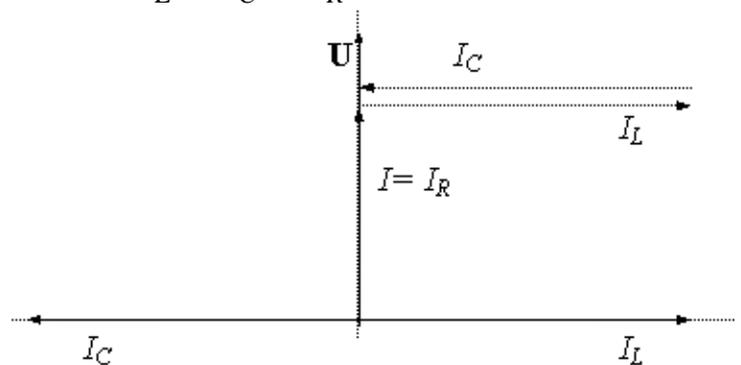
диаграммы, токи через конденсатор и катушку взаимно компенсируют друг друга. Значит, ток в неразветвленной части
