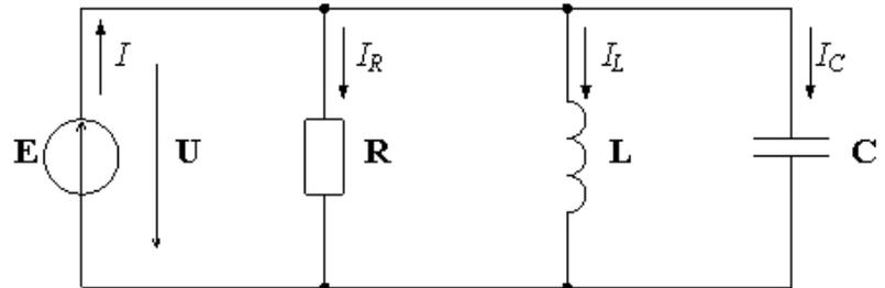
Как видно из условия, наблюдается резонанс токов. Такое возможно при параллельном соединении, изображенном на рисунке. Значит,  $U = U_L = U_C = U_R$ .
