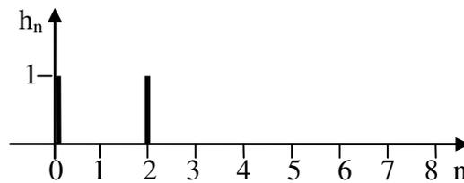
Рисунок 3.11 – Импульсная характеристика фильтра
