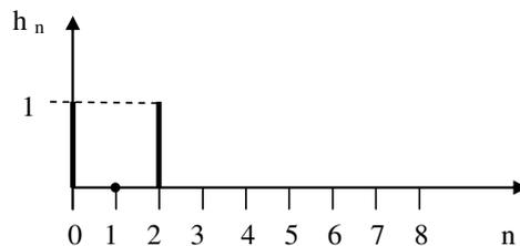
Рисунок 3.6 - Импульсная характеристика фильтра
