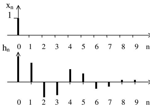
Рисунок 3.2 - Единичный отсчет  $x_n$  и импульсная характеристика  $h_n$
