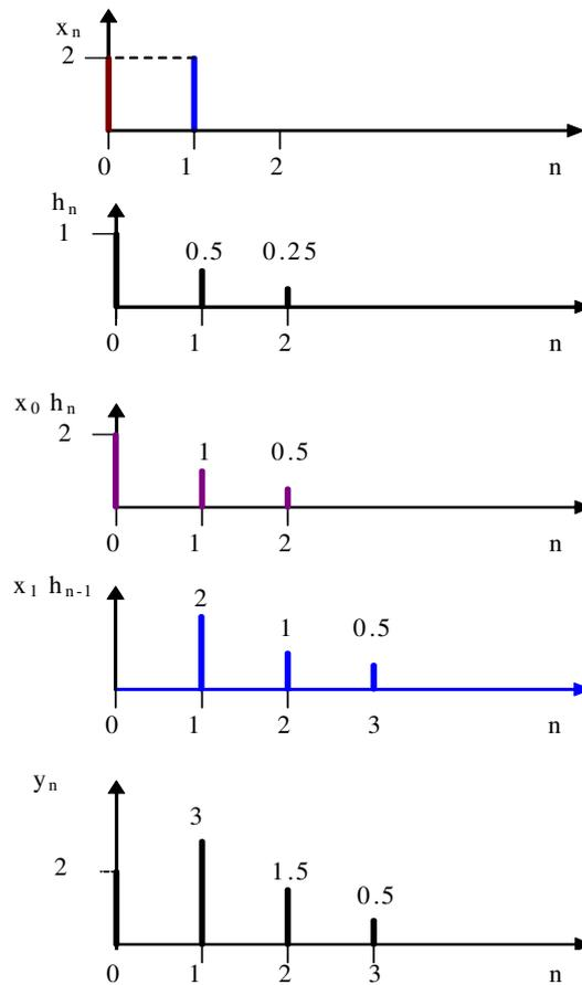
Рисунок 3.3 – Определение выходного сигнала фильтра по входному сигналу и импульсной характеристике
