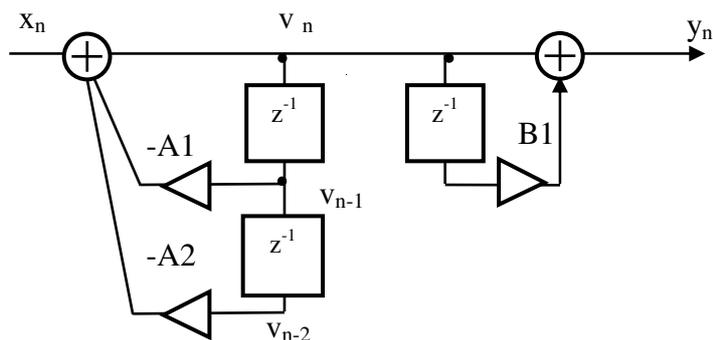
Рисунок 3.13 – Представление цифрового фильтра в виде последовательного соединения двух звеньев
