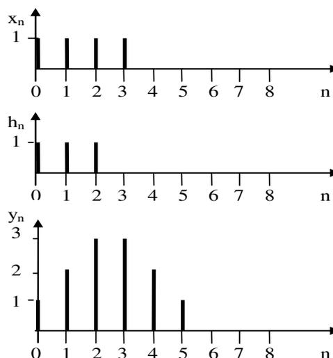
Рисунок 3.8 – Временные диаграммы импульсной характеристики, входного и выходного сигналов
