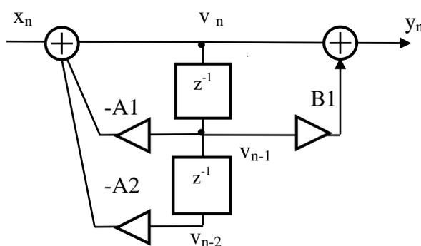
Рисунок 3.14 – Каноническая форма фильтра
