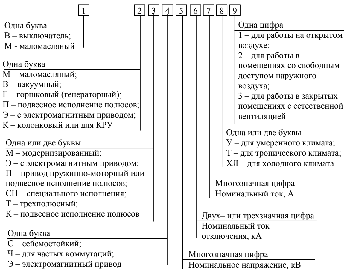
Рис. 7.2. Структура условного обозначения выключателей высокого напряжения
