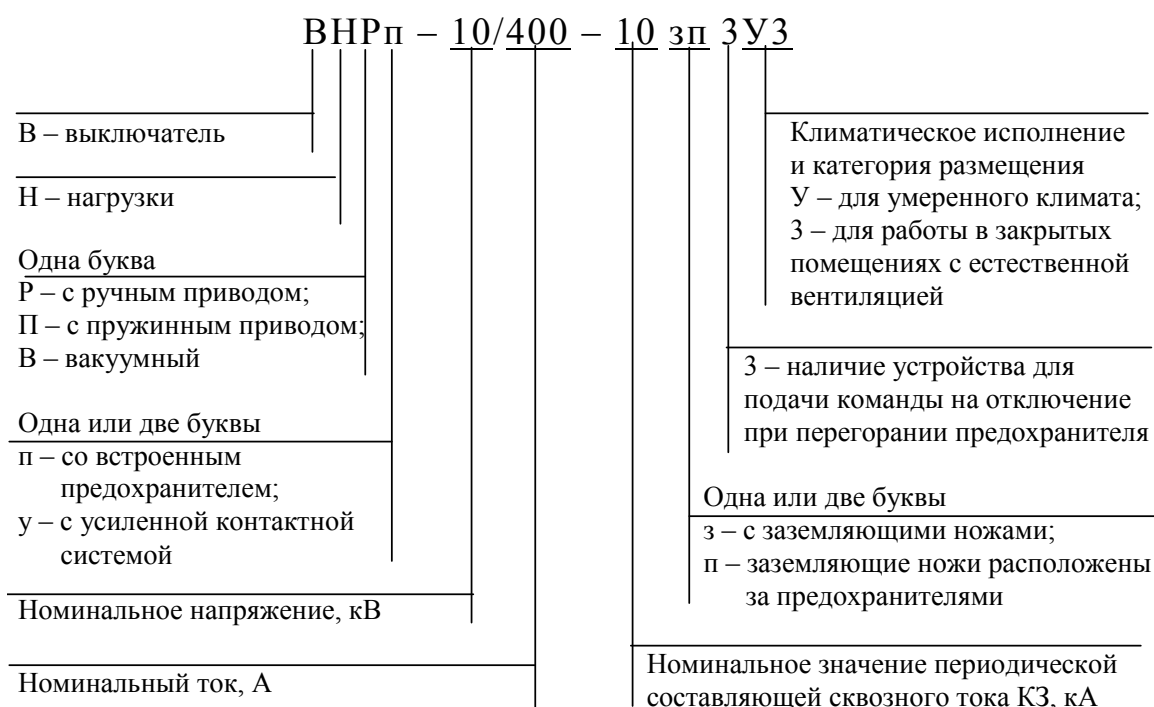
Рис. 7.3. Структура условного обозначения выключателей нагрузки
