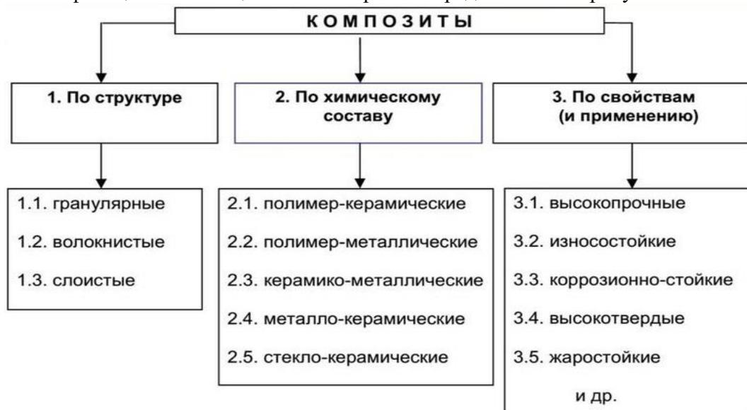
**Рисунок 11** - Классификация композиционных материалов
