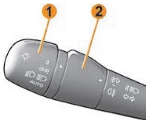
Рис. 9. Кольца управления на рычаге переключателя 1 - Кольцо управления наружным освещением. 2 - Кольцо управления противотуманными огнями.
