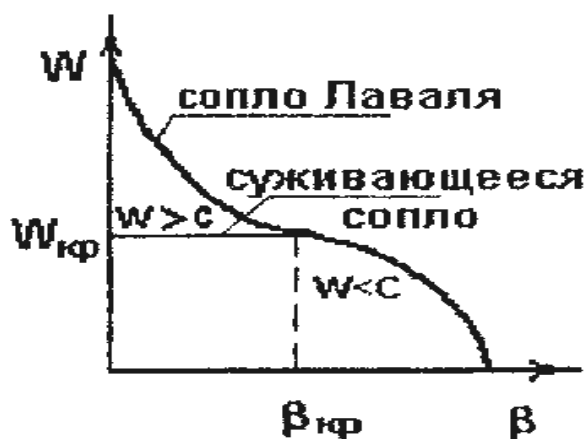
Рисунок 8.4 – Изменение скорости газа на выходе из суживающегося сопла и сопла Лавали
