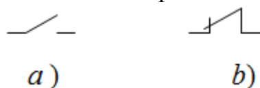
Рис. 1.1. Положение ключа: а) до коммутации б) после коммутации.
