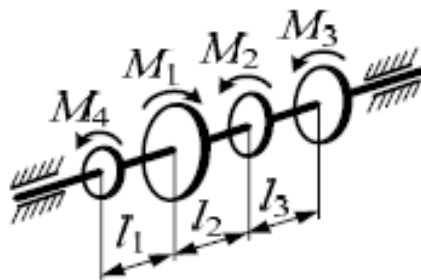
Рисунок 3.1. – Схема расположения шкивов на валу
