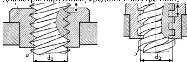
Рис. 5.5. Винтовые пары с прямоугольной и треугольной резьбой:
