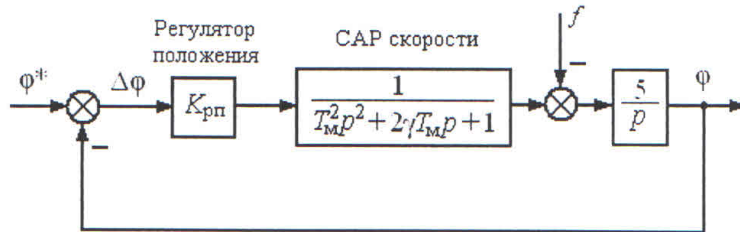
Рис. 5. Структурная схема системы регулирования положения
