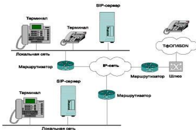
Рис. 5.3. Архитектура сети реализации IP-телефонии с использованием SIP-протокола.
