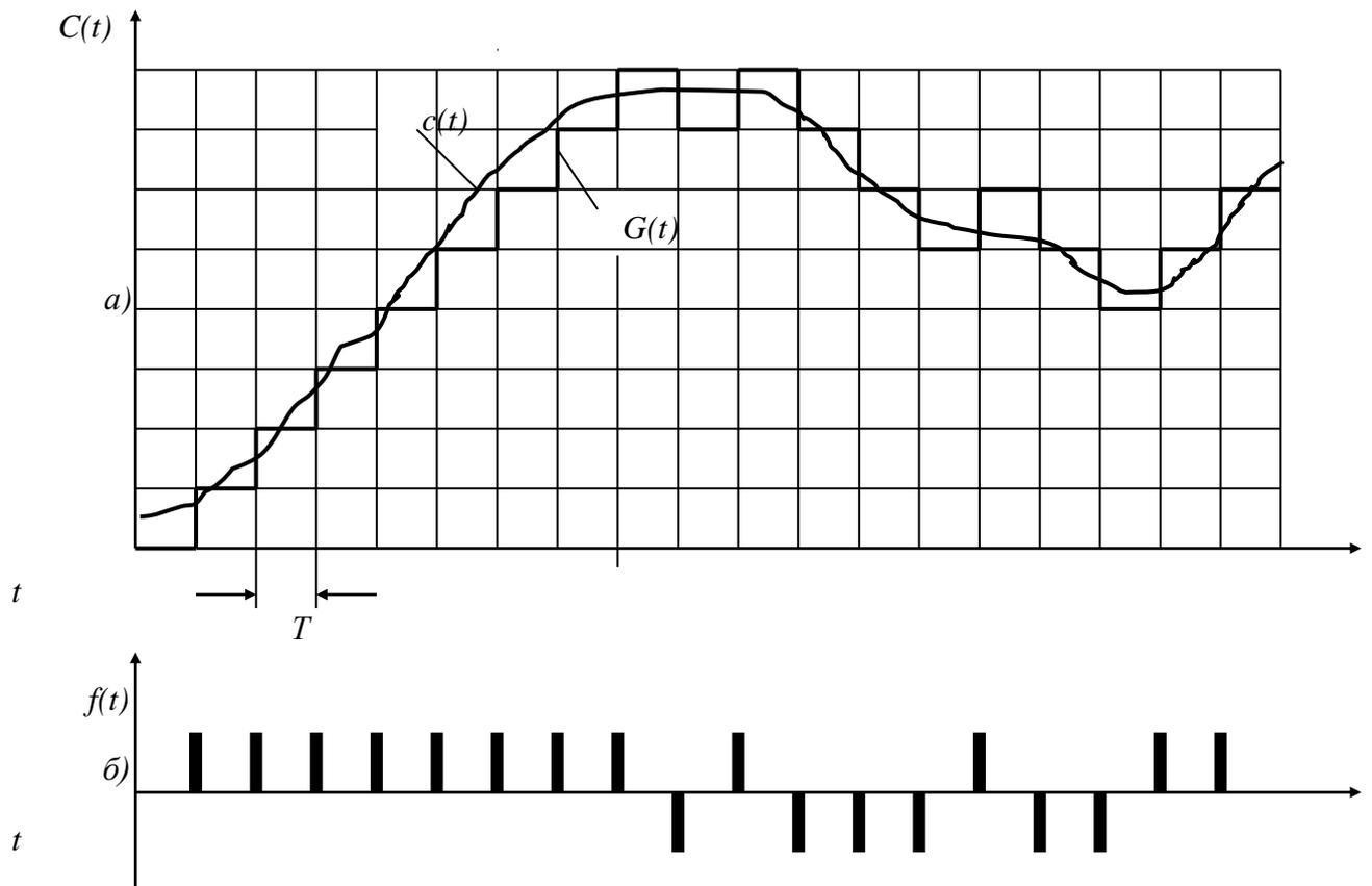
Рисунок 8. Дельта-модуляция
