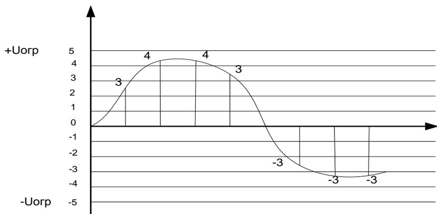
Рисунок 7. Симметричное кодирование
