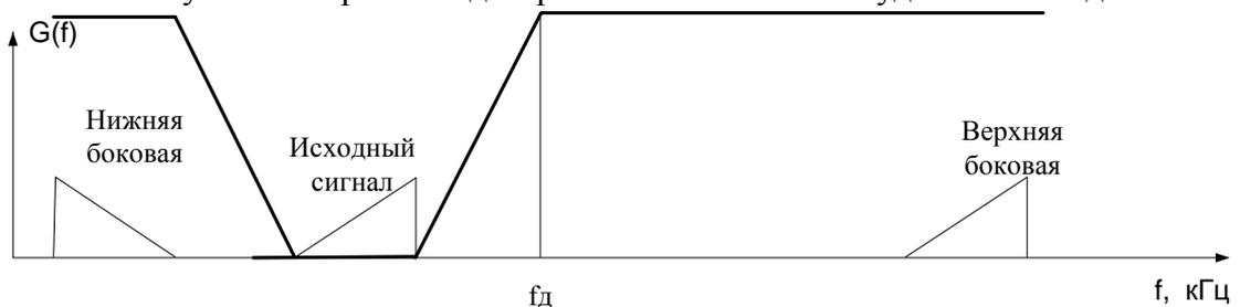
Рисунок 5. Спектральная диаграмма при дискретизации «узкополосных» сигналов
