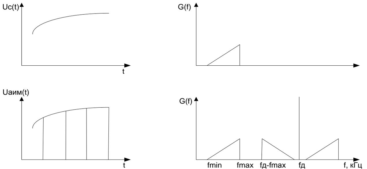
Рисунок 3. Графики первичного сигнала  $U_c(t)$ , его спектр, а так же амплитудно - импульсно модулированного сигнала  $U_{aим}(t)$  и его спектр
