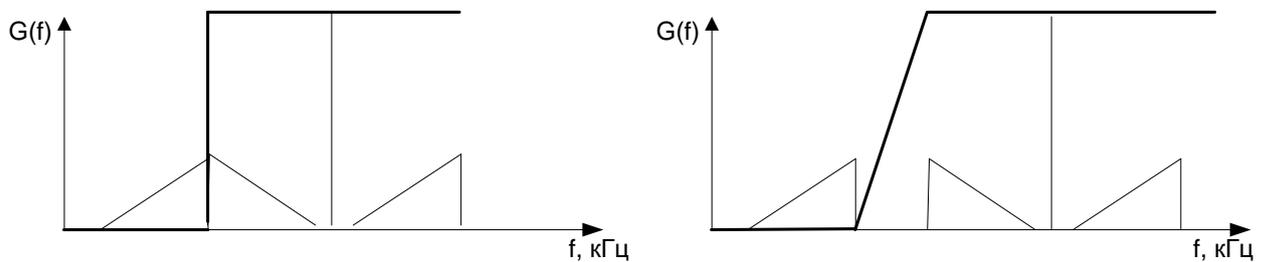
Рисунок 4. Пояснения к вопросу об искажениях при дискретизации АИМ сигнала
