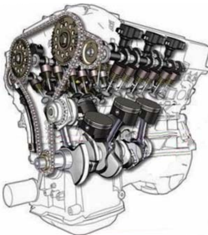
Рис. В.40. V-образная схема расположения цилиндров ДВС, в которой цилиндры и КМ размещаются в ряд с развалом от 10^\circ до 120^\circ в форме латинской буквы «V»
