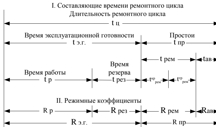
Рис. 8.1. Составляющие времени ремонтного цикла t_{ц} и режимные коэффициенты R_i
