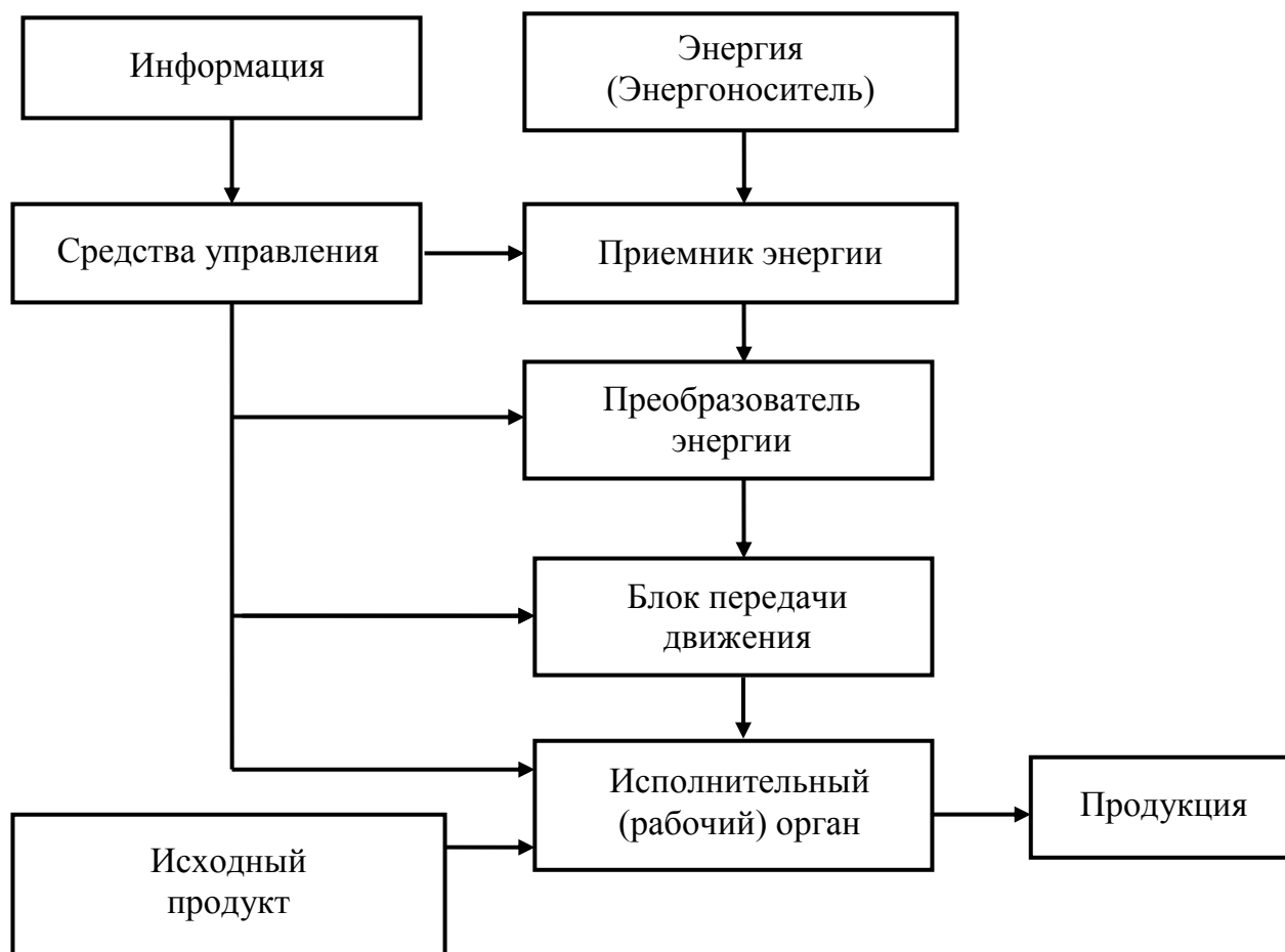
Рис. 2.1. Общая структура машины
