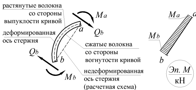
Рис. 2. Построение эпюры изгибающих моментов на участке стержня
