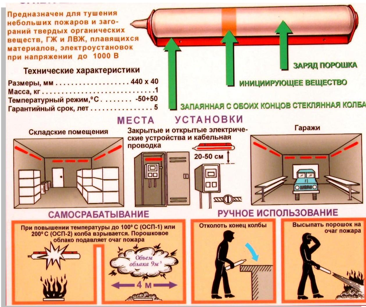
Рис. 8.15. Принцип действия самосрабатывающего огнетушителя
