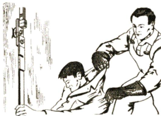
*Рис. 4.11.* Освобождение пострадавшего от токоведущих частей с использованием топора
