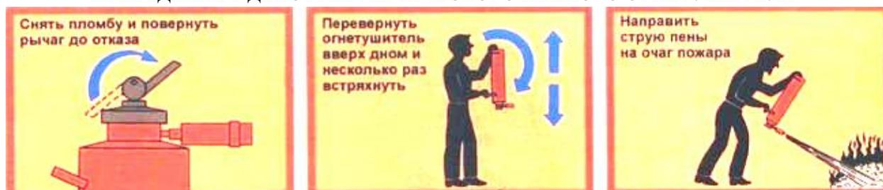
Рис. 8.8. Принцип действия химического пенного огнетушителя типа ОХП
