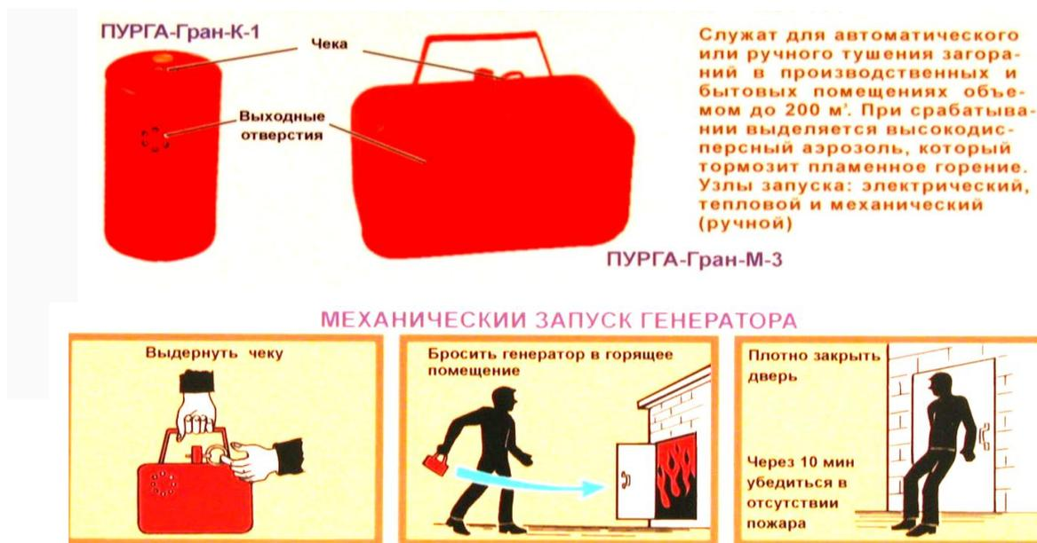
Рис. 8.17. Принцип действия аэрозольных генераторов ручного действия
