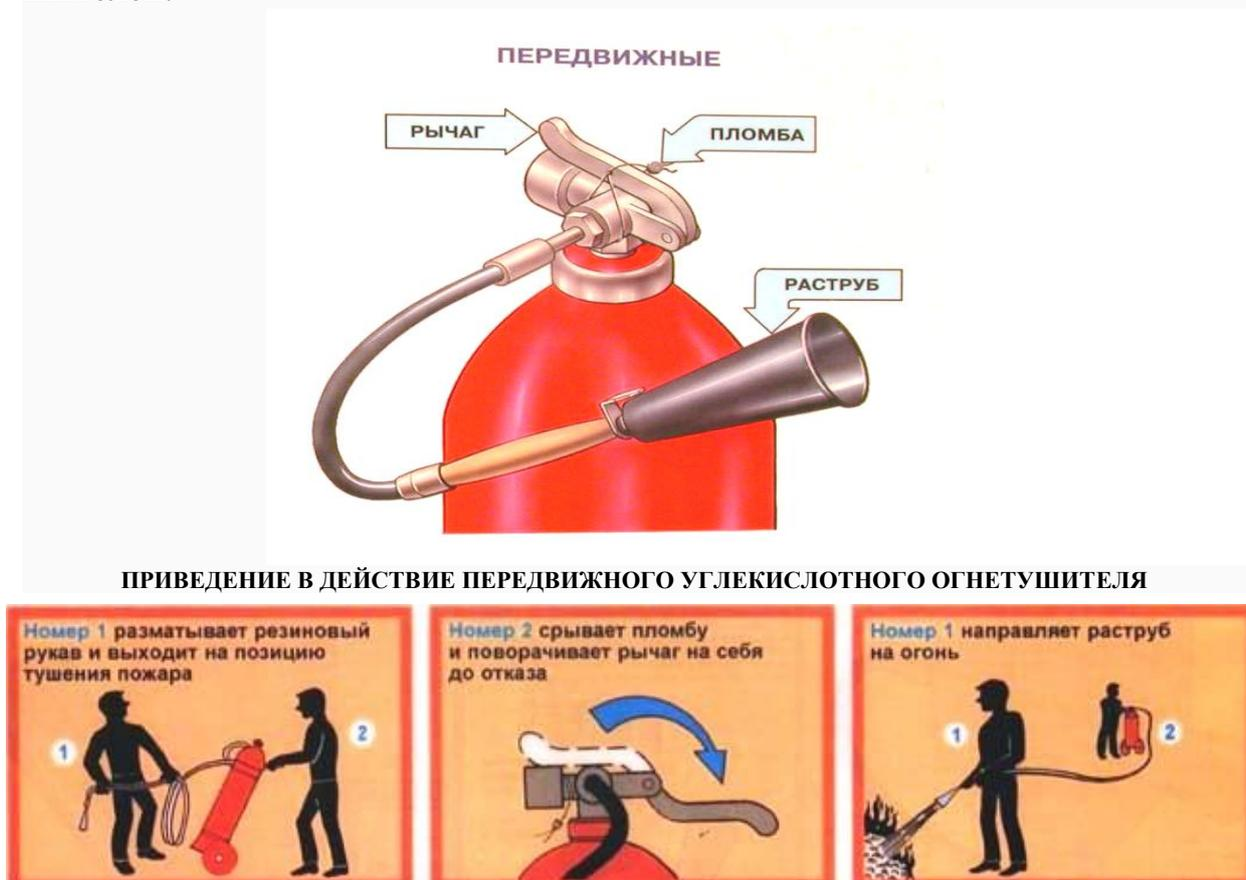
Рис. 8.13. Принцип действия углекислотного огнетушителя передвижного типа
