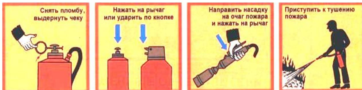
Рис. 8.9. Принцип действия воздушно-пенного огнетушителя типа ОВП
