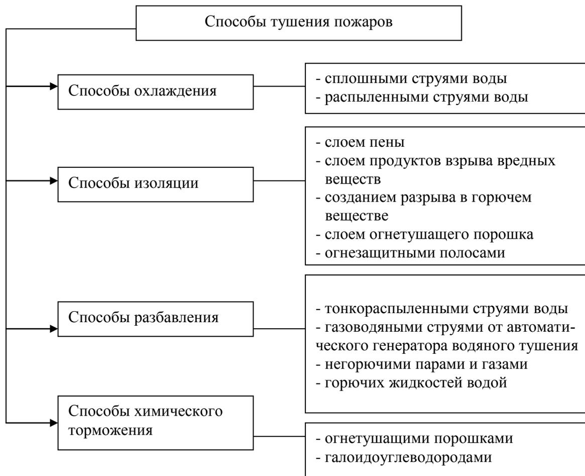
Рис. 8.1. Способы тушения пожаров
