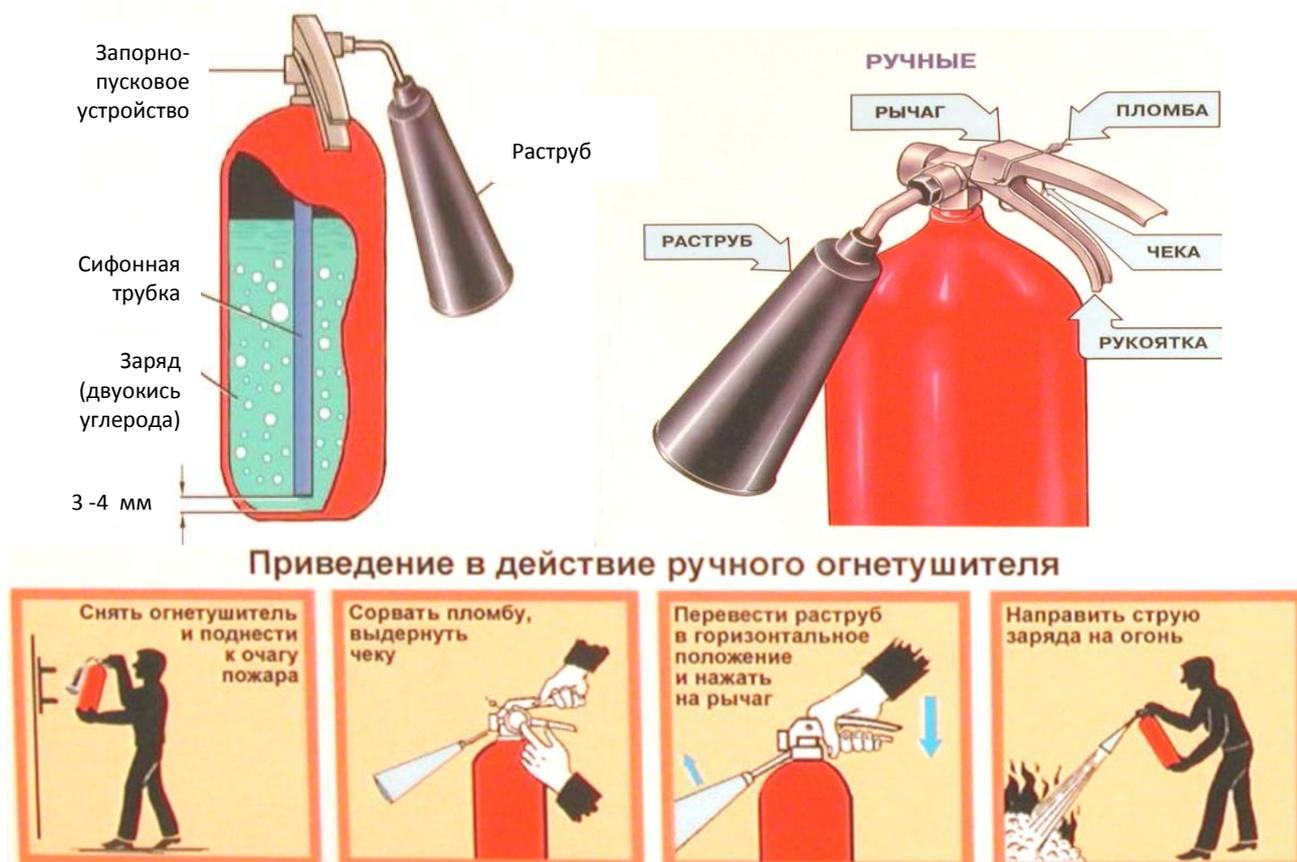
Рис. 8.10. Принцип действия углекислотного огнетушителя ручного типа
