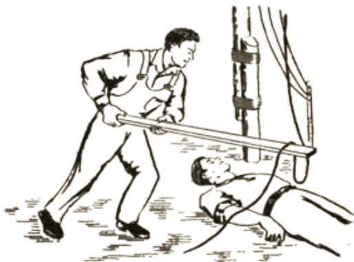
*Рис. 4.12. Освобождение пострадавшего от токоведущих частей с использованием неметаллических предметов, например палки*
