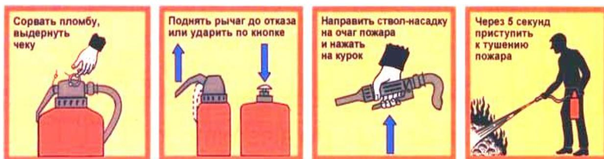
Рис. 8.5. Принцип действия огнетушителя со встроенным источником давления
