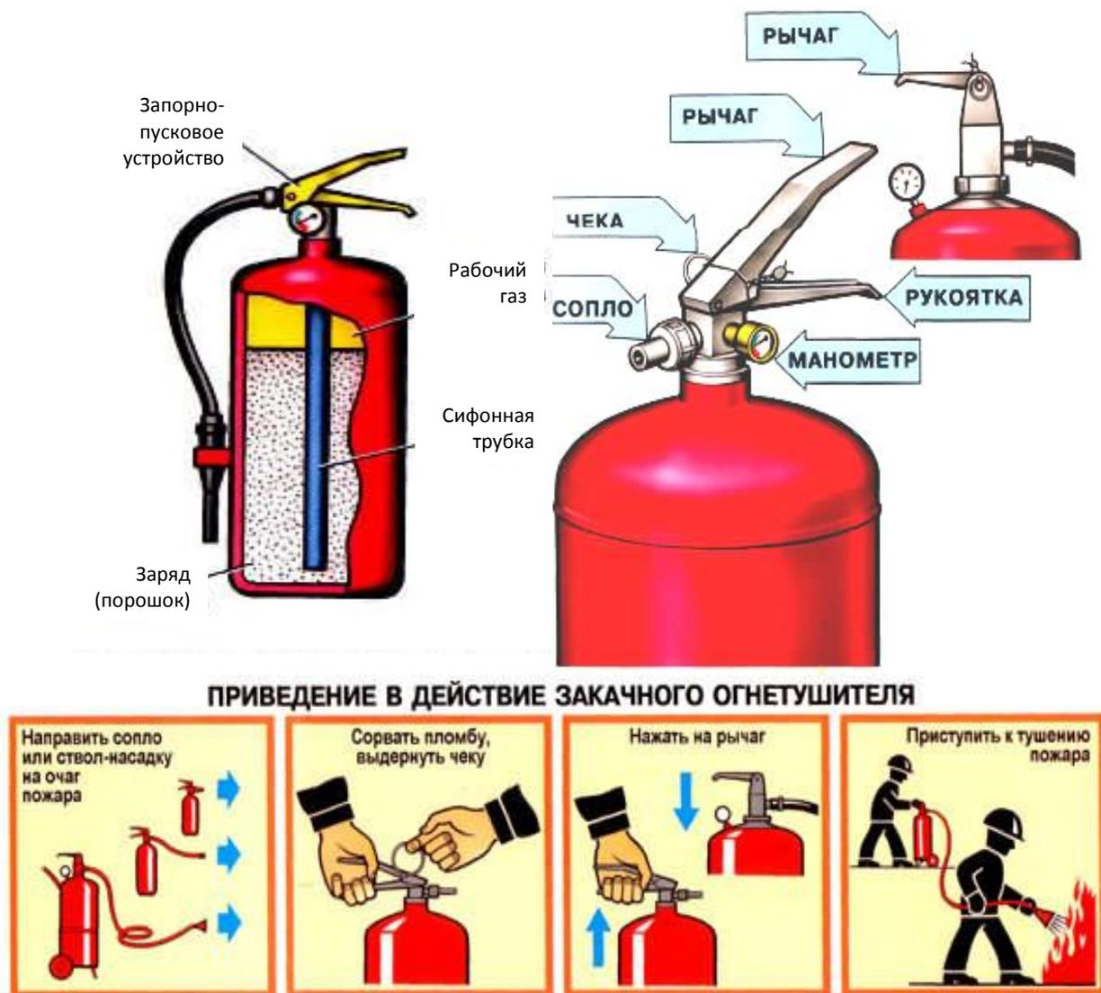
Рис. 8.4. Принцип действия закачного порошкового огнетушителя
