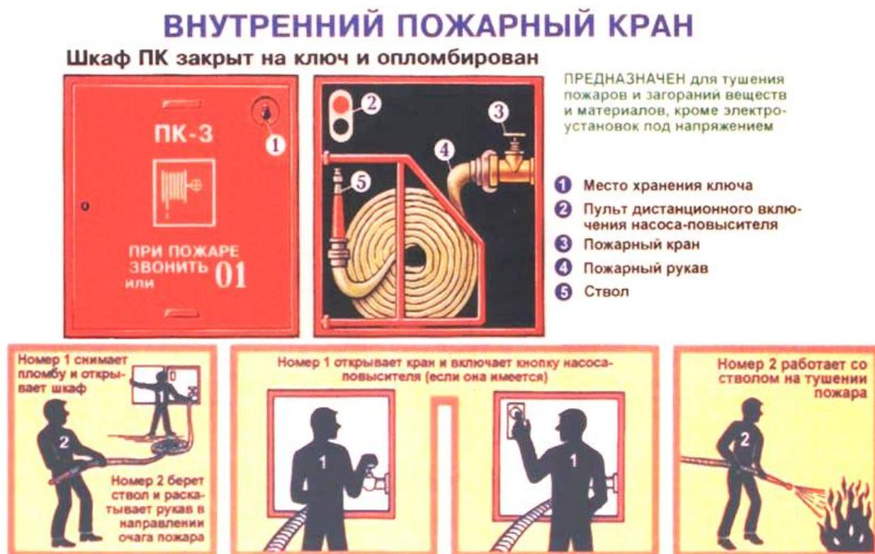
Рис. 8.3. Внутренний пожарный кран и действия при пожаре
