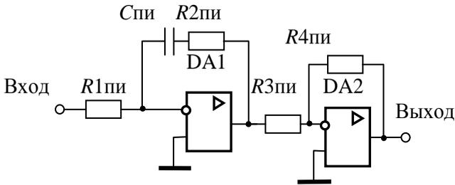
Рис. 5.17 — Модель ПИ-регулятора
