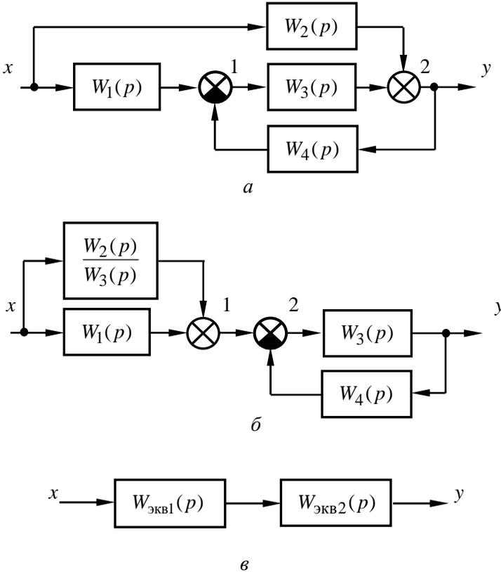
Рис. 4.3 — Структурная схема устройства (а) и её преобразования (б, в)
