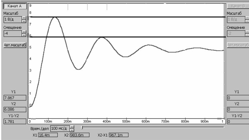
Рис. 5.4 — Измерения с помощью горизонтальных маркеров
