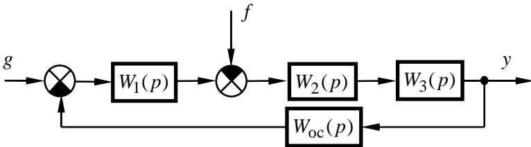
Рис. 4.7 — Структурная схема САУ к примеру 4.8
