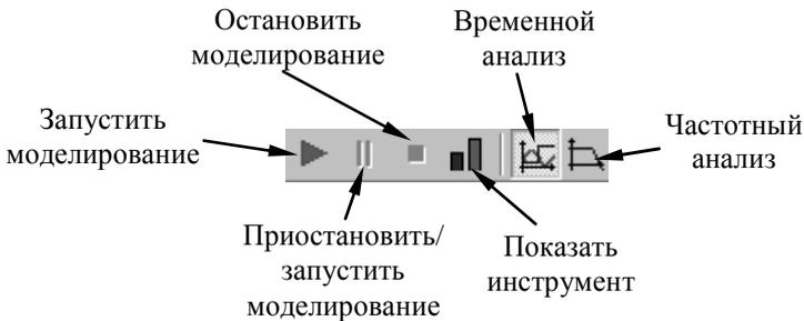
Рис. 5.2 — Панель управления процессом моделирования в ASIMEC
