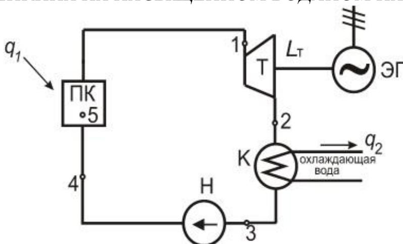
Рисунок 1 -Схема паротурбинной установки:
