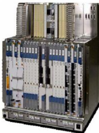
Рис. 3.3. Полка универсального мультиплексора SDH U-NODE WBM
