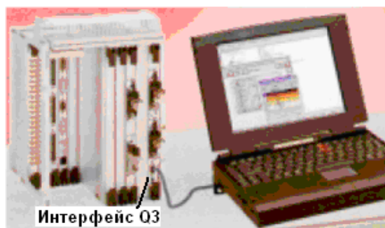
Рис. 5.7. Пример подключения терминала управления 1320СТ к мультиплексу SDH через интерфейс Q3
