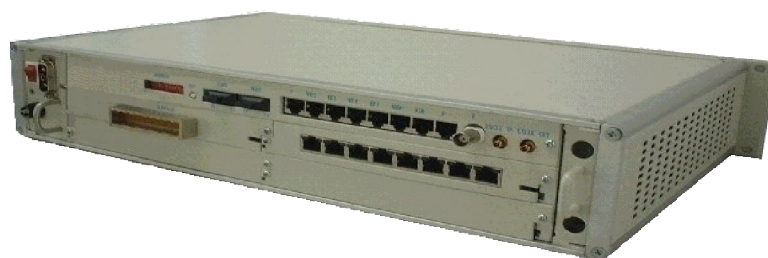
Рис. 3.5. Конструкция «мини» мультиплексора SpectralWave C-Node
