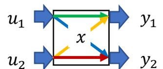
Передаточная функция выхода  $y_1$  относительно входа  $u_2$  равна
