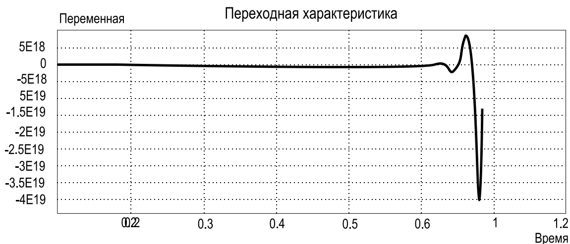
Рис. 4. Переходная характеристика исходной САР
