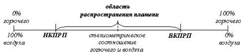
Рисунок 1 – Зависимость концентрационных пределов от содержания окислителя
