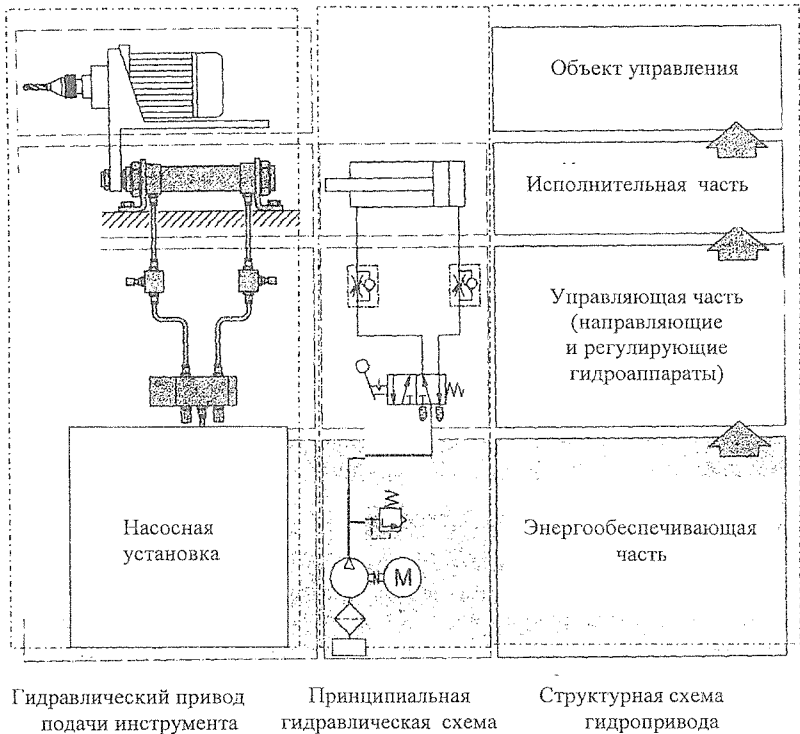
Рис. 1.1. Структурная схема гидропривода с ручным управлением
