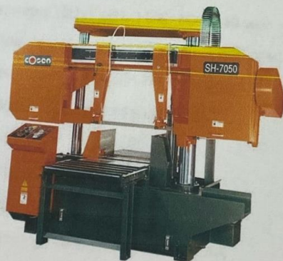
Рисунок 2 – Ленточнопильный станок SH-7050.
