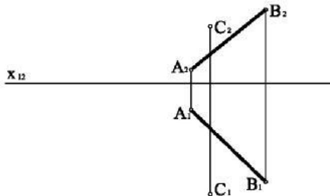
2. Построить проекции отрезка  $AB$  частного положения, у которого точка  $A \in \pi_2$ , а точка  $B$  равноудалена от плоскостей  $\pi_1$  и  $\pi_2$ .
