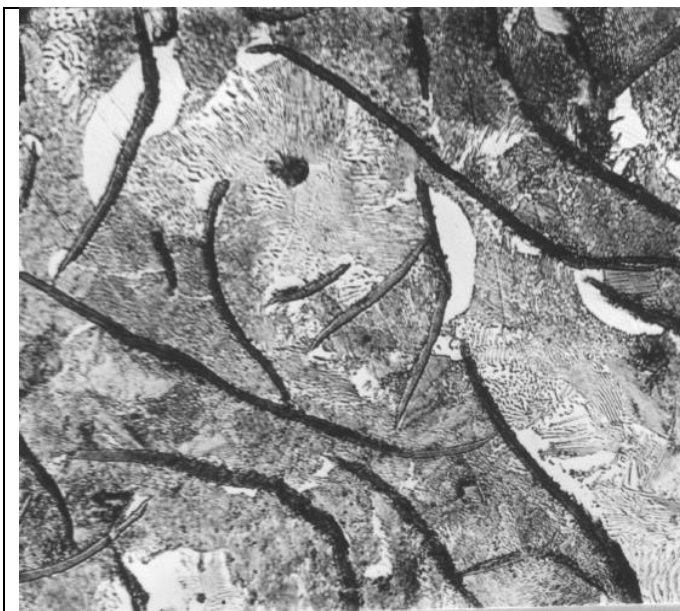
Рис. 6. Микроструктура серого чугуна на феррито-перлитной основе
