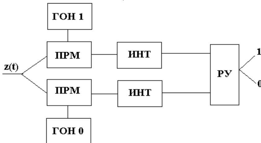
Рис.10 - Структурная схема корреляционного ОП
