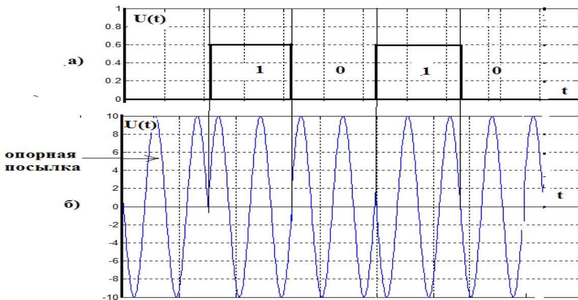
Рис.14 - Временные диаграммы двоичного сигнала и сигнала ДОФМ
