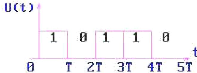
Рис.2 - Временная диаграмма двоичного сигнала
