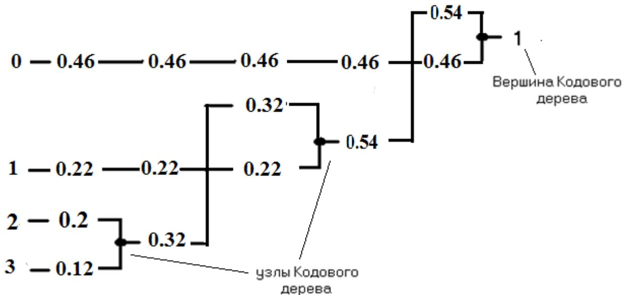
Рис.16. Построение кодового дерева.
