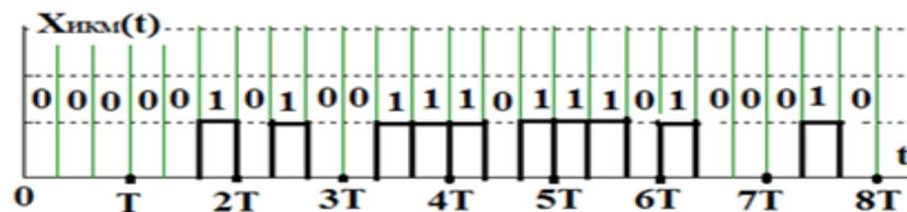
Рис.3 - Преобразование аналогового сигнала в сигнал ИКМ
