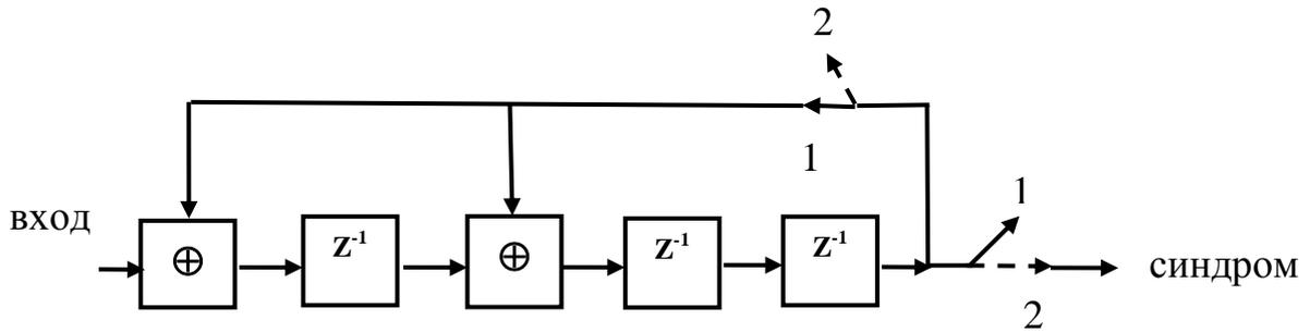
Рис.7 - Структурная схема декодера циклического кода (7,4)
