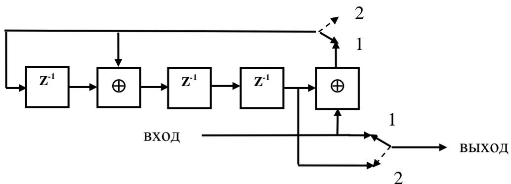
Рис.6 - Структурная схема кодера циклического кода (7,4)
