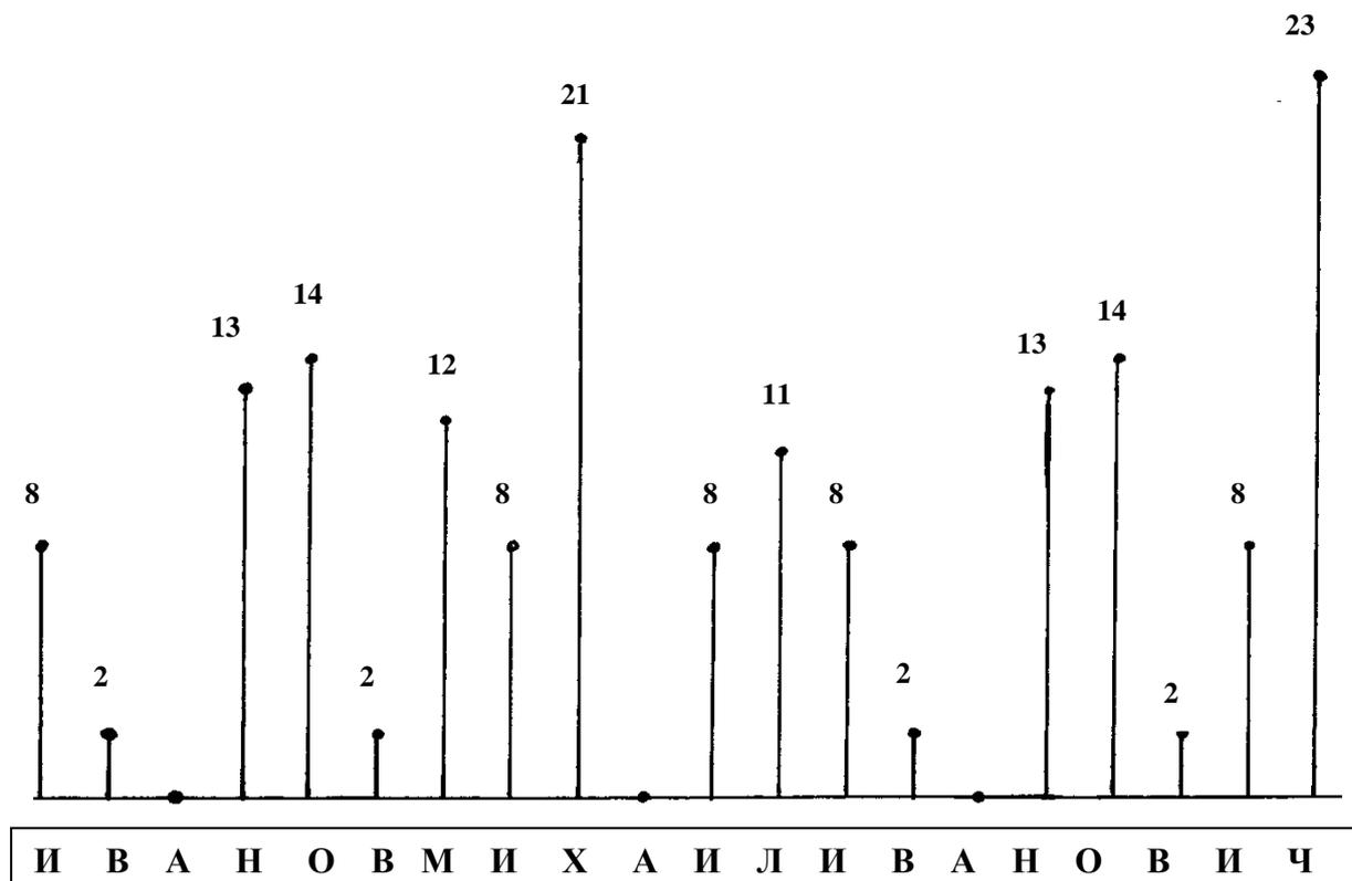
Рис. 15 - Квантованный сигнал передаваемой последовательности
