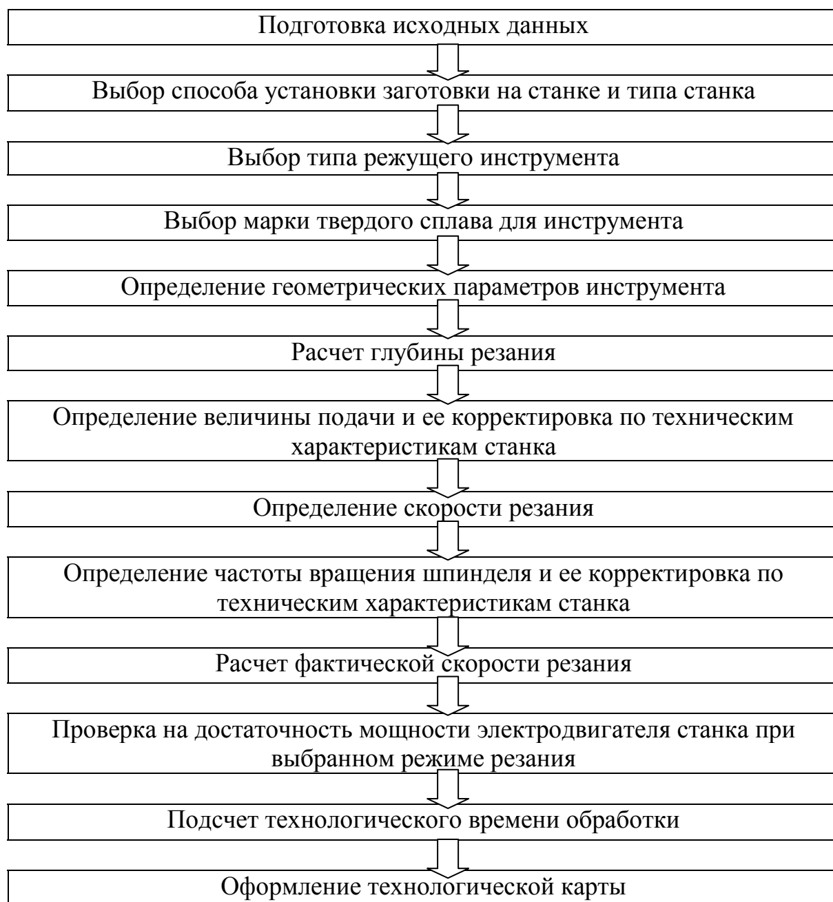
Рис. 2. Обобщенный алгоритм расчета режимов резания при механической обработке заготовок
