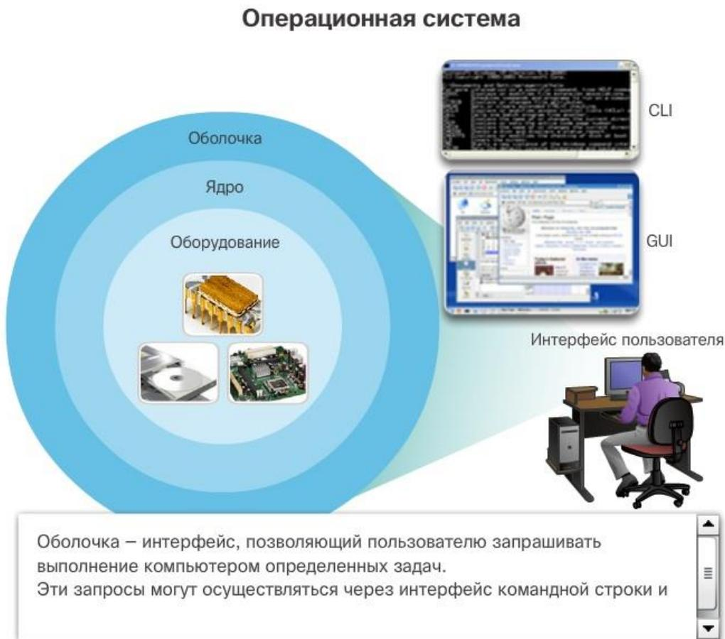
Рис. 1.12 – Схема взаимодействия операционной системы с оборудованием
