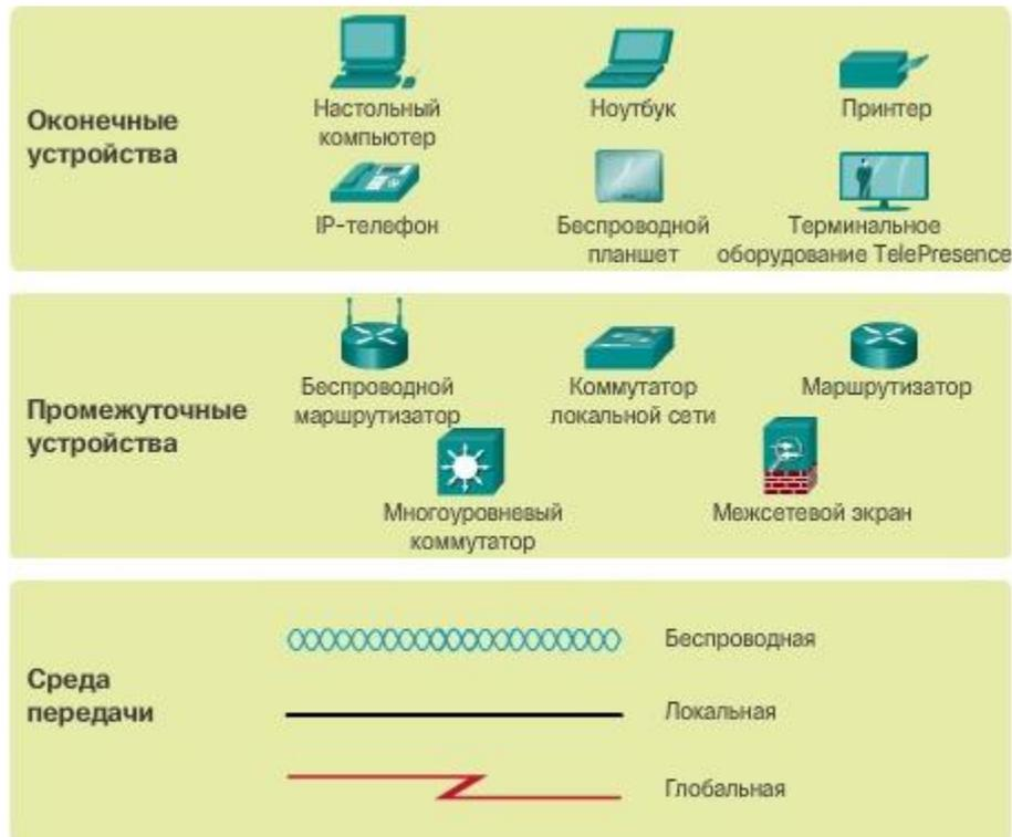
Рис. 1.5 – Сетевые обозначения
