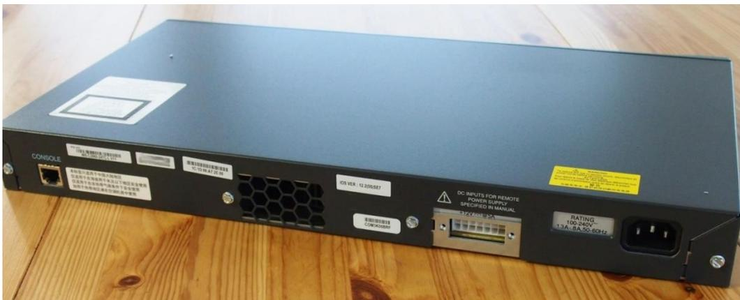
Рис. 1.11 – Вид коммутатора сзади
