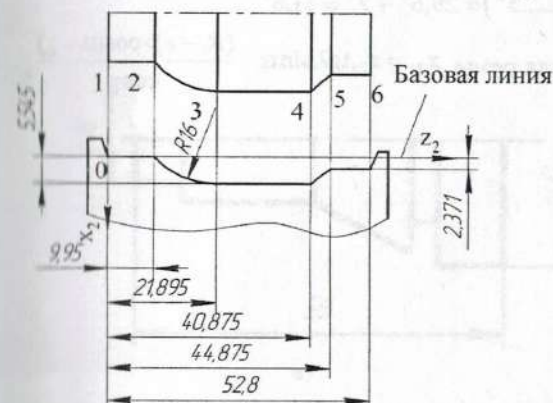
Рис. 1.5. Профиль призматического резца
