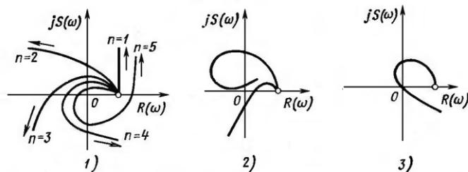
Рис. 1. Амплитудно-фазовые характеристики критерия Михайлова. 1. – устойчивая система, 2 – неустойчивая система, 3 – система на границе устойчивости.
