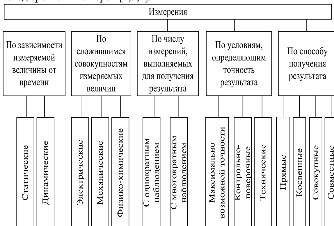
Рисунок 3 - Классификация измерений
