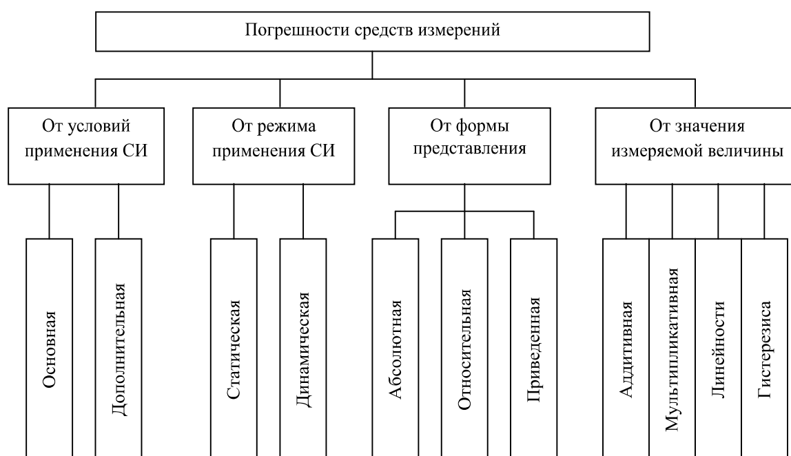
Рисунок 3.2- Классификация погрешностей средств измерений
