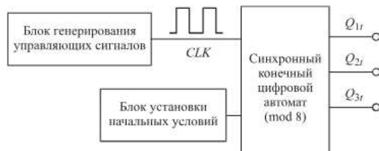
Рис. 2.1. Блок-схема синхронного конечного цифрового автомата: Q_{1r} — младший разряд; Q_{2r} — средний разряд; Q_{3r} — старший разряд
