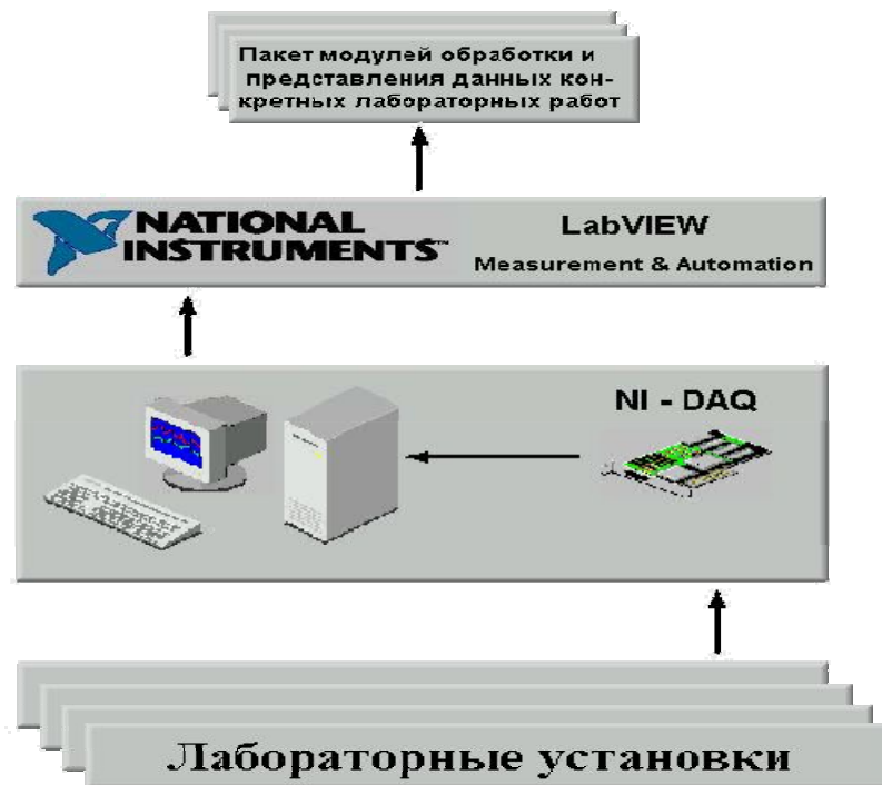
Рисунок 1 - Платформа технических и программных средств, использованная для автоматизации измерений и обработки данных
