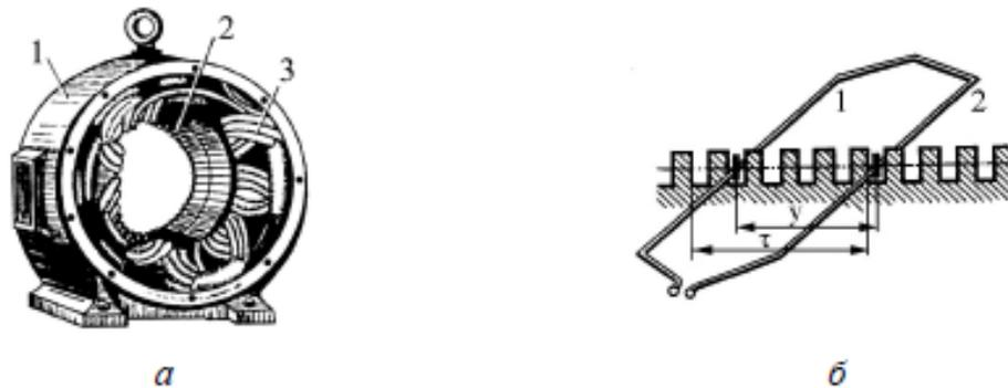
Рис. 8.1. Статор асинхронного двигателя (а) и размещение обмоток в пазах (б)
