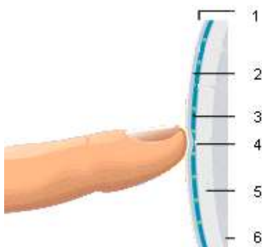
Рис. 1.8. Устройство резистивной сенсорной панели. Давление пальца вызывает электрический контакт между проводящим и резистивным слоем.
