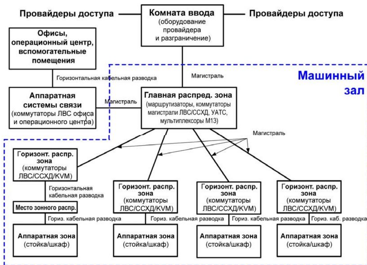
Рис.4.5. Базовая топология ЦОД
