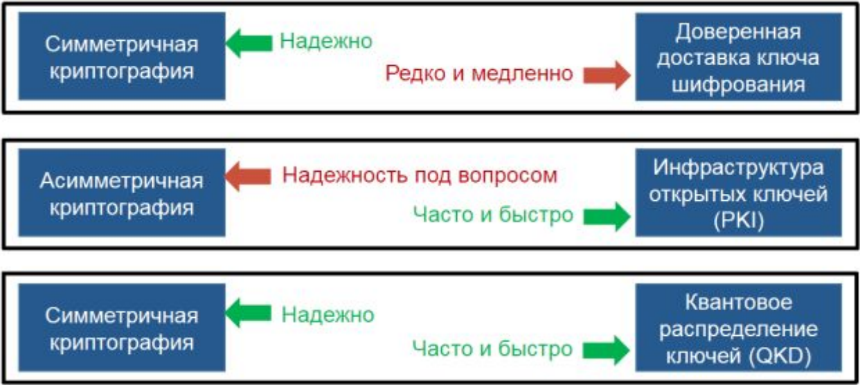
Рис.2.14. Подходы к выработке ключей шифрования
