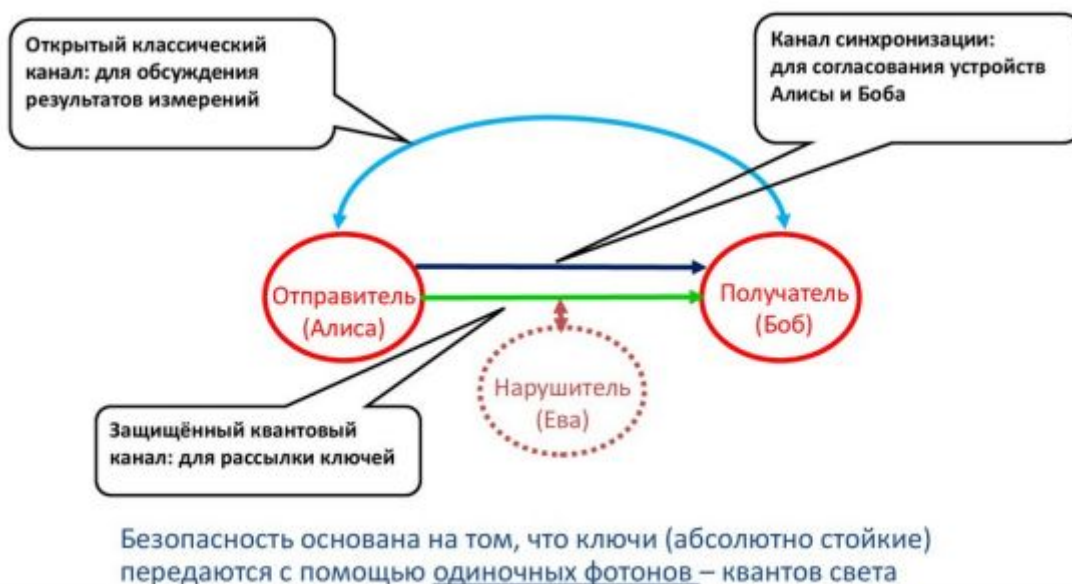
Рис.3.5. Схема квантовой рассылки ключа
