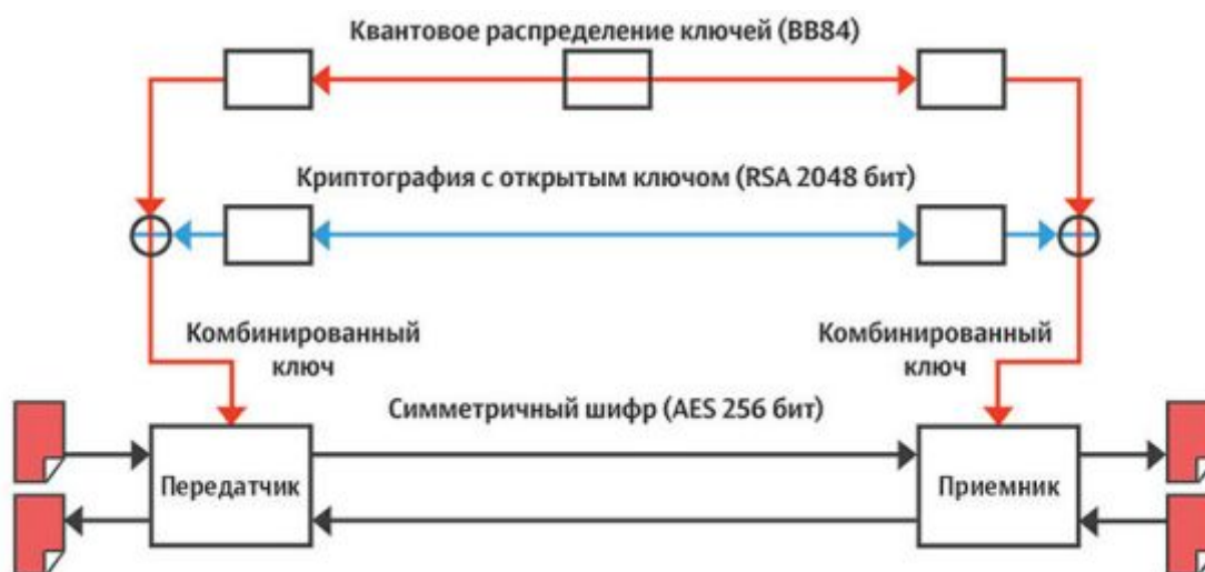
Рис.3.6. Схема формирования комбинированного ключа шифрования на основе протоколов: BB84 (квантовый протокол) и RSA2048 (несимметричный ключ)
