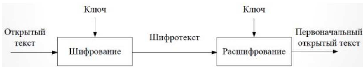
Рис.2.9. Схема симметричного шифрования
