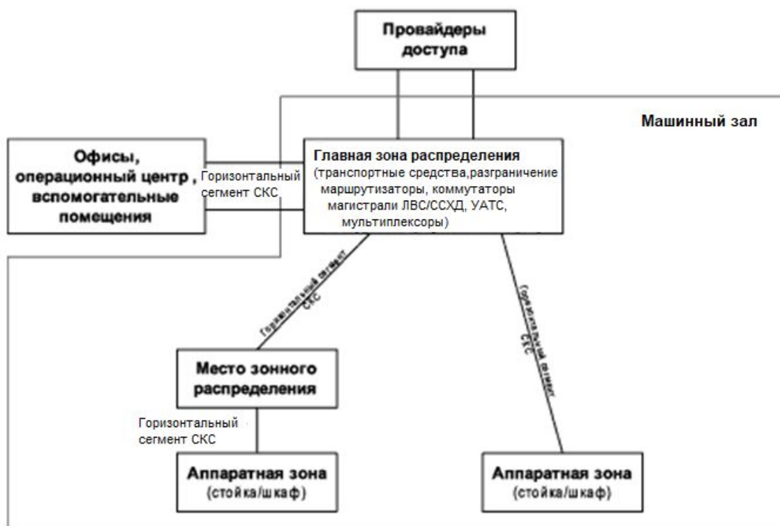
Рис.4.4. Упрощенная топология ЦОД
