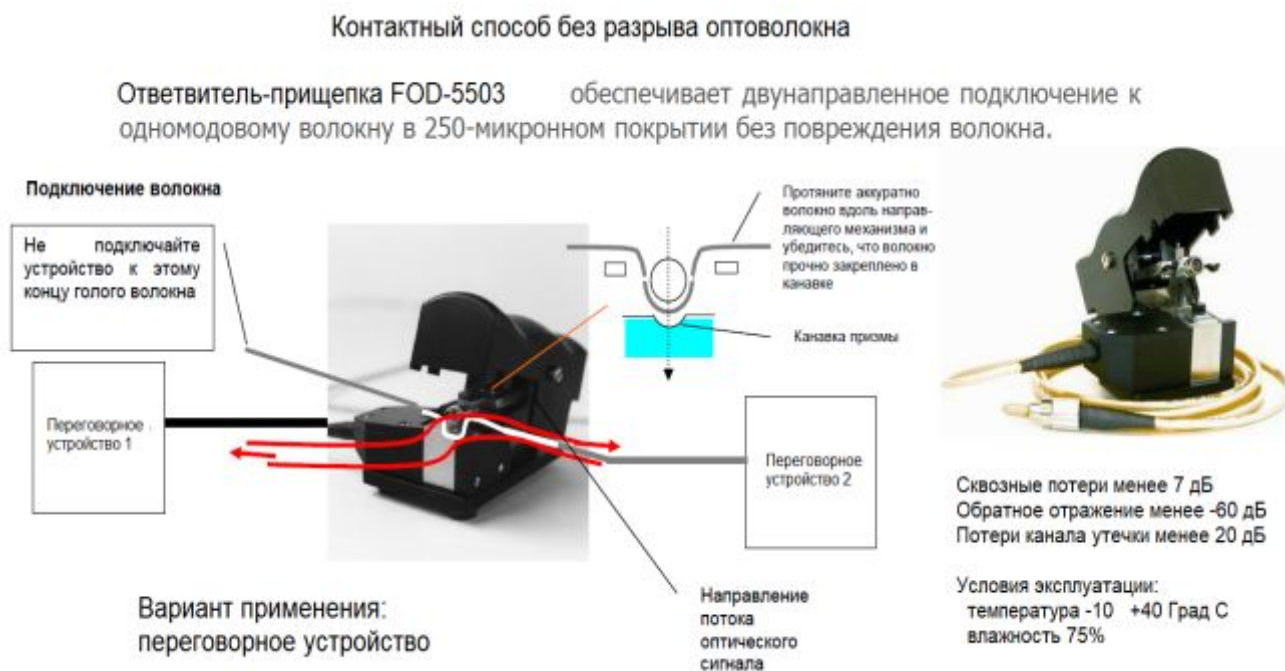
Рис.1.33. Контактное приборное подключение к оптоволокну
