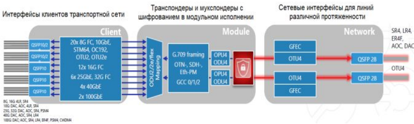
Рис.2.27. Транспондер/мукспондер с функцией шифрования L1
