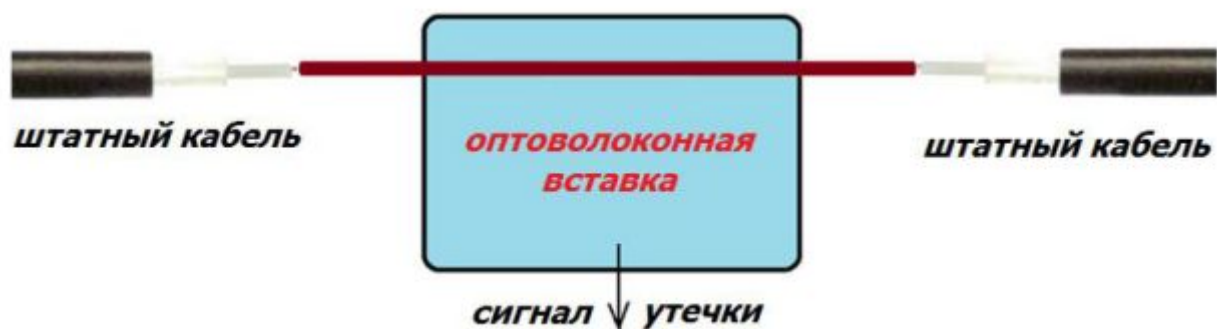
Рис.1.20. Контактный способ с разрывом волокна
