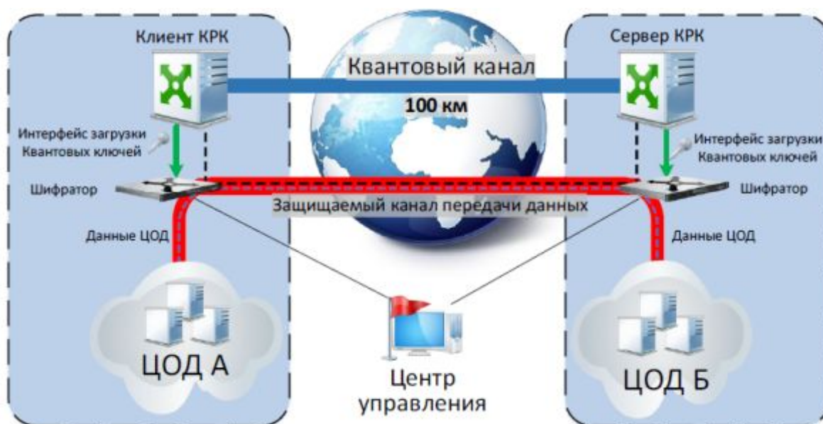
Рис.3.16. Участок применения оборудования VipNet Quantum Security System между ЦОД
