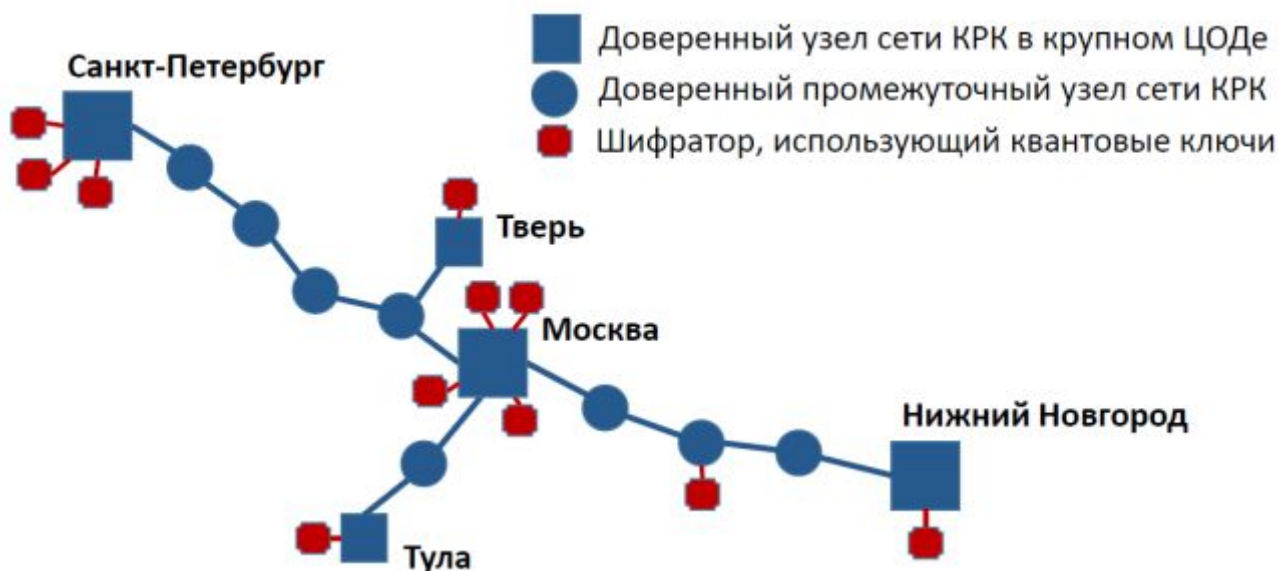
Рис.3.20. Пример использования ViPNetQuandor в магистральной транспортной сети
