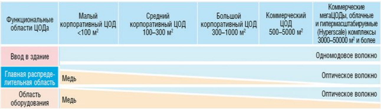
Рис.4.28. Рекомендация по применению физической среды соединений в ЦОД
