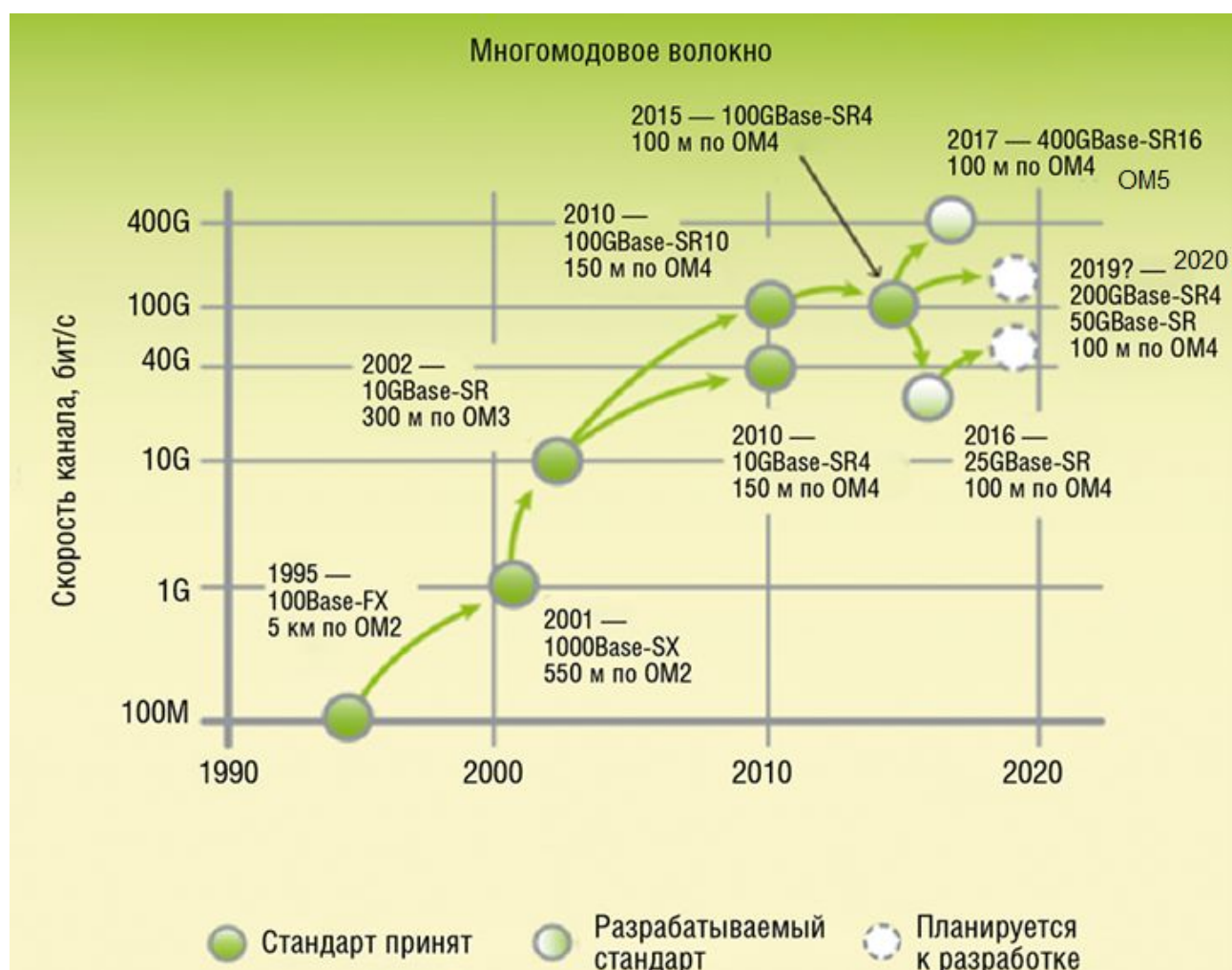
Рис.4.9. Достижения для оптических многомодовых волокон ЦОД
