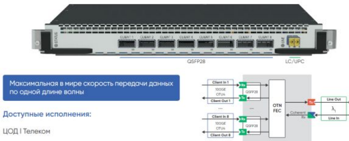
Рис. 4.38. Оборудование для организации высокоскоростных межсоединений ЦОД – мукспондер 8×100Гбит/с
