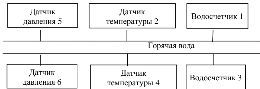
Рис. 4.54. Структурная схема узла подсистемы горячего водоснабжения
