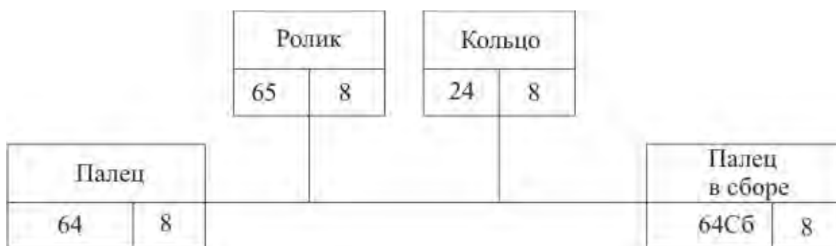
Рисунок 5 – Технологическая схема комплектной сборки пальца (поз.64)
