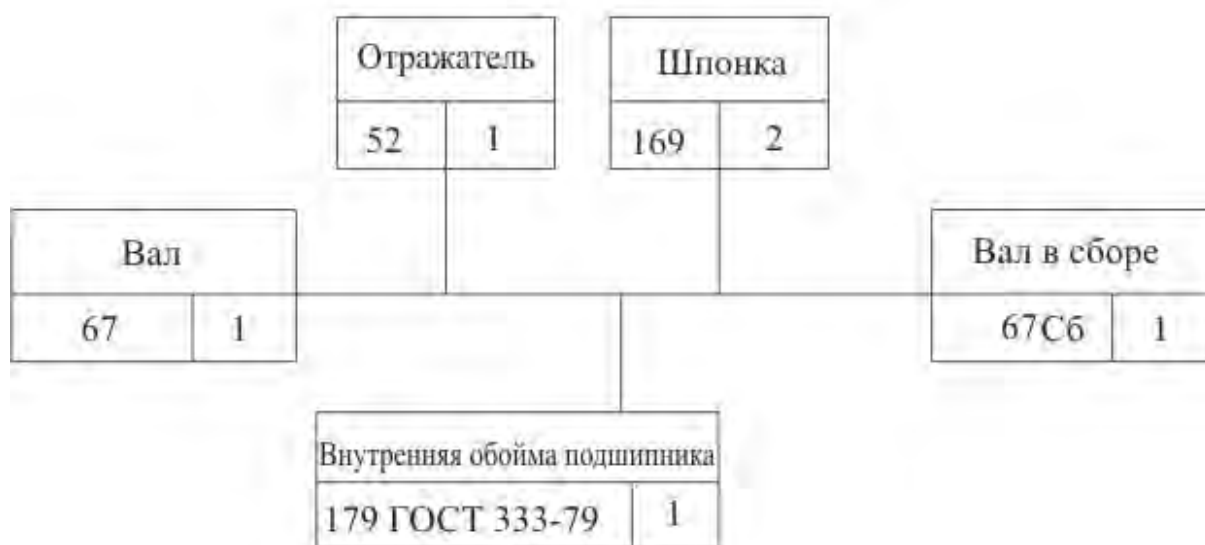
Рисунок 6 – Технологическая схема комплектной сборки вала (поз.67)
