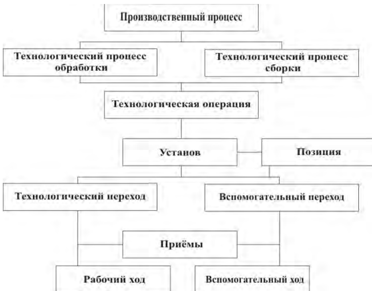
Рисунок 1 – Структура производственного процесса
