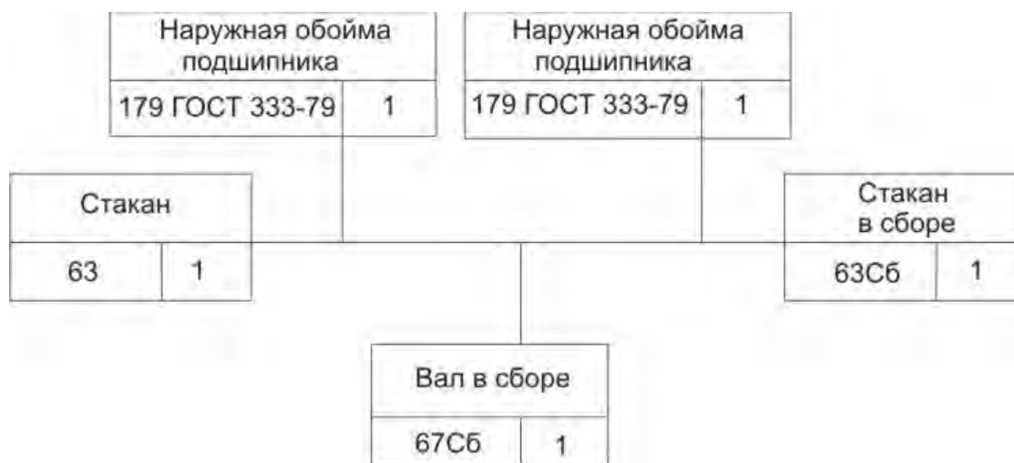
Рисунок 8 – Технологическая схема подузловой сборки стакана (поз.63)
