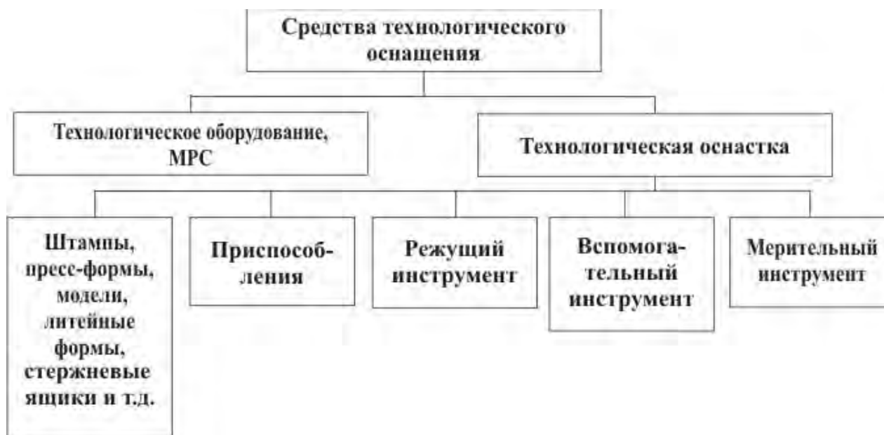
Рисунок 2 – Структура средств технологического оснащения
