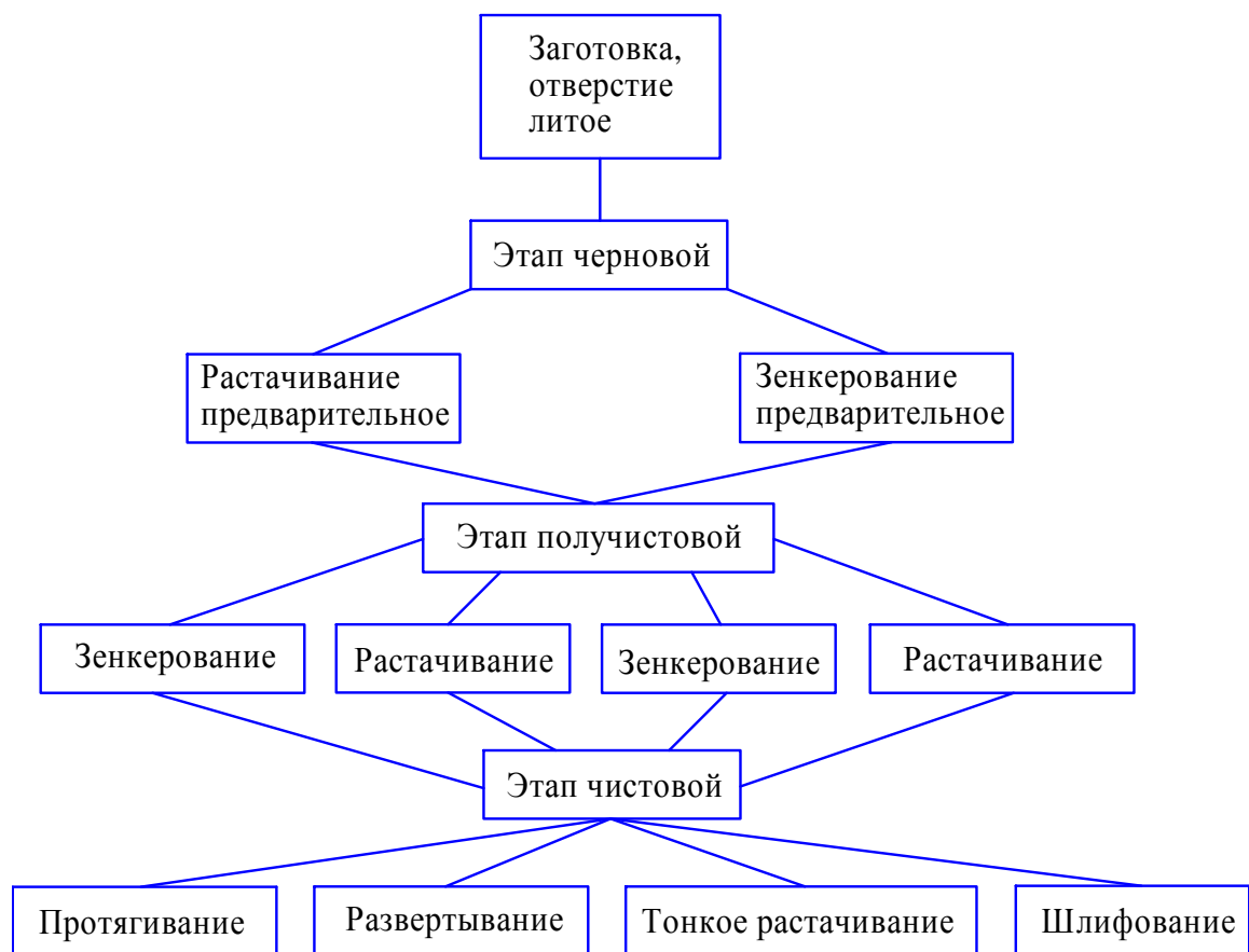
Рисунок 17 - Варианты обработки отверстия
