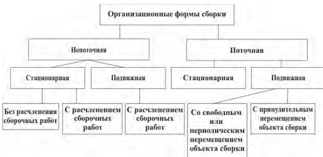
Рисунок 9 – Организационные формы технологических процессов сборки изделия
