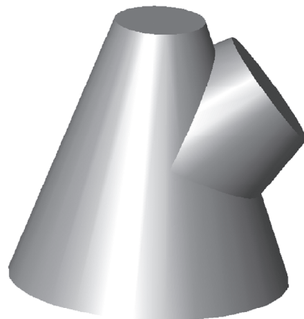
Рис. 4.6. Построение проекции линии пересечения поверхностей вращения 2-го порядка, описанных вокруг общей сферы
