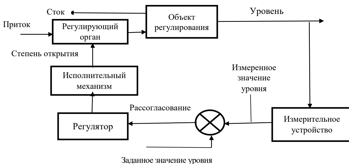
Рис. 1.4. Структурная схема АСР уровня в емкости
