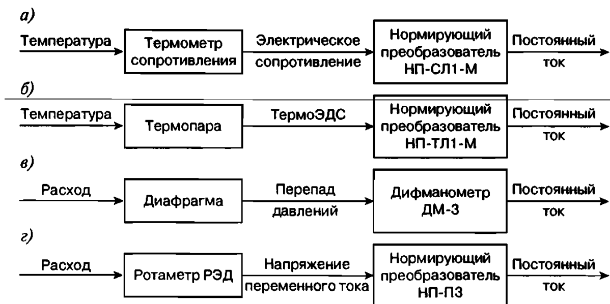
Рис. 3.7. Примеры измерительных цепей регулятора «Ремиконт»: а – с термометром сопротивления; б – с термопарой; в – с диафрагмой; г – с ротаметром
