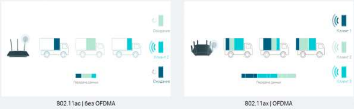
Рис. 3.26. Распределение ресурсов в разных версиях Wi-Fi
