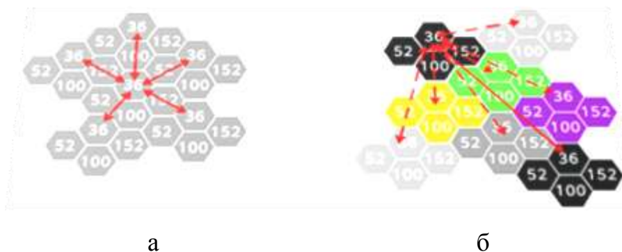
Рис. 3.30. Колорирование: а – сеть без раскраски, все устройства используют канал; б – раскрашенная сеть передача в канале только внутри одного цвета
