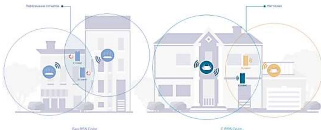
Рис. 3.31. Колорирование внутри помещений
