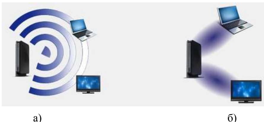
Рис. 3.18. Технологии Wi-Fi сетей: а) – с обычной антенной; б) – с технологией beamforming
