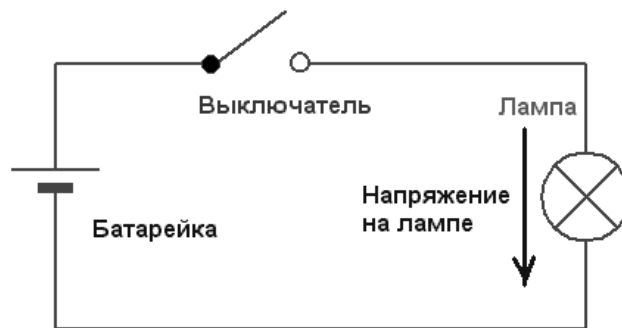
Рисунок 3.4 – Электрическая схема цепи и электролампы
